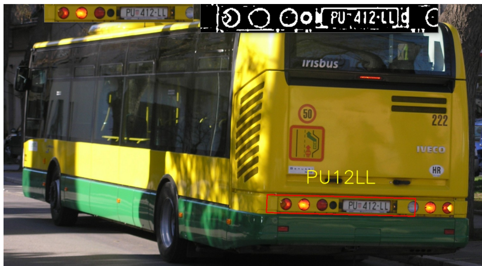
Slika 39. Djelomična detekcija – primjer 2
