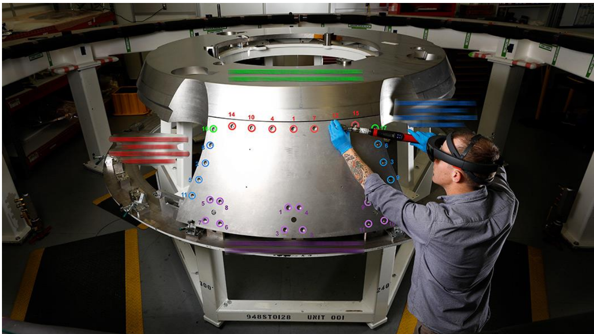
Slika 42. Primjena proširene stvarnosti prilikom montaže
