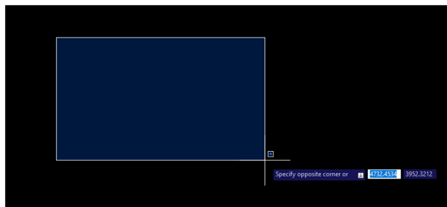
Slika 2.2 - Plavi odabir (s lijeva na desno) – Završni rad.dwg
