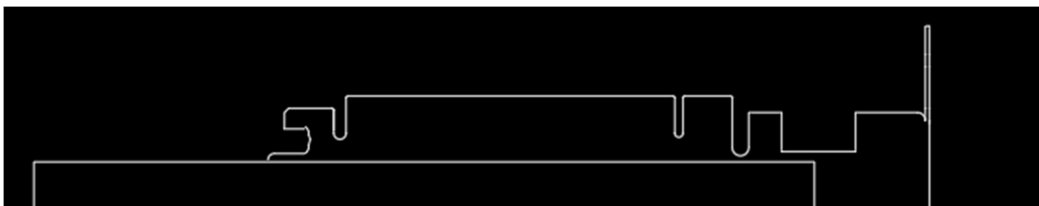
Slika 3.11 – Dio zaslužan za spajanje grafičke kartice za matičnom pločom prikazan u tlocrtu – Završni rad.dwg
