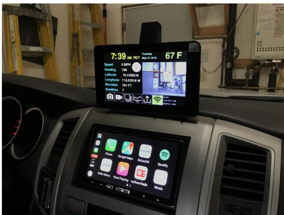
Slika 13 - Carputer kodiran u Pythonu-u baziran na Raspberry Pi, ugrađeno u Toyotu (izvor: https://github.com/jbuehl/carputer )
