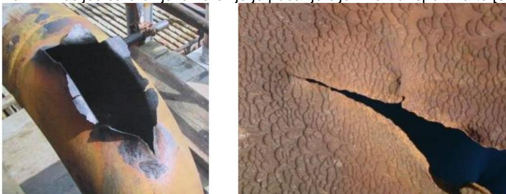
Kavitacijska korozija oblik je erozijske korozije koji nastaje mehaničko-elektrokemijskim djelovanjem. Mehaničku fazu čine nastanak mjeđurića plina i njihovog pucanja u blizini metalne površine, te elektrokemijska korozija na predjelima gdje su mjeđurići bili u kontaktu sa metalom. Kavitacija je posljedica razlike tlaka. Često se pojavljuje na propelerima brodova i lopaticama turbina. Primjer je kavitacijskog oštećenja brodski vijak prikazan na slici 12. [3, 21]
