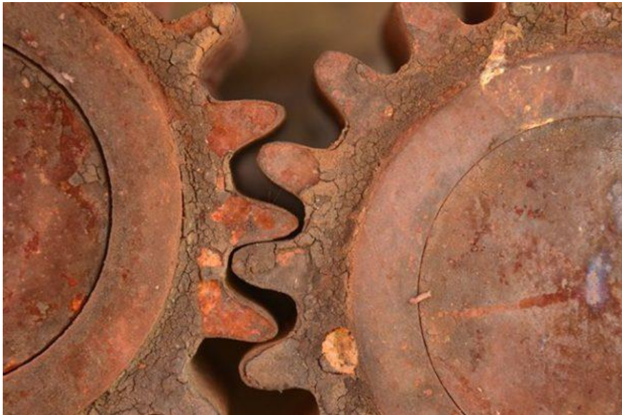
Slika 2: Opća korozija na zupčanicima [16]
