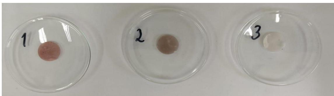
Za FT-IR analizu izrađene su tri pastile kalijeva bromida (slika 42), analizirano je oko 3 mg strugotina svakog uzorka. Za prvu je pastilu strugana naslaga crvene korozije na unutarnjoj strani uzorka 3. Druga je pastila za analizu uzorka naslaga oko pukotine, a treća je pastila načinjena od naslaga s vanjske strane uzorka 3. Nakon izrade, pastile su sušene na 60°C kako bi se uklonila suvišna vлага kroz 24 sata.
