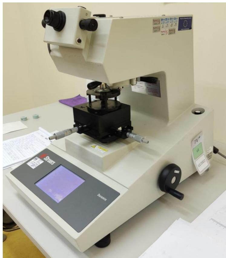
U praksi se uzima se u obzir pet mjerena tvrdoće. Najprije se uređaj umjerava mjerenjem tvrdoće etalona<sup>8</sup>. Izvršeno je ukupno 10 mjerena, 5 s unutarnje strane i 5 s vanjske strane cijevi, a rezultati su prikazani u poglavljiju *Analiza rezultata*. Mjerenje je tvrdoće prema Vickersu obavljeno prema normi HRN EN ISO 6507 - 1:2018. Na uzorku su vidljivi otisci mjerenja tvrdoće (slika 41).
