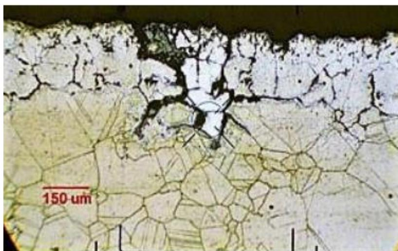
Selektivnom korozijom elementi legure se razdvajaju. Dvije su teorije zašto dolazi do korozije u ovom slučaju. Prva, jedan se element legure prilikom topljenja taloži na površini. Druga, selektivnim razaranjem jednog metala, dolazi do poroznog ostatka plemenitijeg metala. No, u oba slučaja dolazi do gubitka čvrstoće, tvrdoće i elastičnosti metala zahvaćenog korozijom. [24] Primjerice, decinkacija mjeđi dovodi do puknuća (slika 7).
