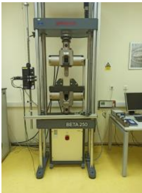
Slika 17: Univerzalna statička kidalica MESSPHYSIK BETA 250
