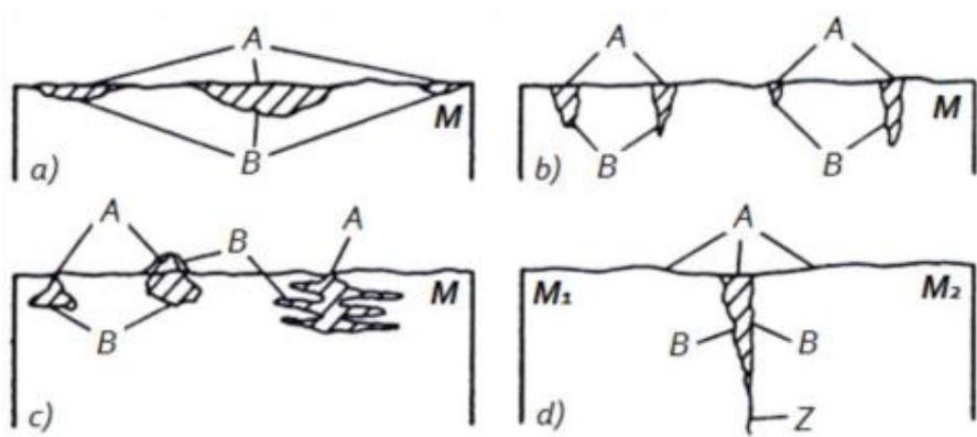
Rupičasta korozija elektrokemijski razara metal. Ovu je vrstu lokalizirane korozije teško otkriti prije pojave rupa. Slojevita lokalizirana korozija događa se ispod površine materijala, u samom središtu rupičaste korozije. Prepoznatljiva je prema mjehurima koji izbijaju na površinu metala proizvedenih slojevitim koroziskim produktima. [18] Primjer noža na slici 4 pokazuje oštećenje pjegastom korozijom.
