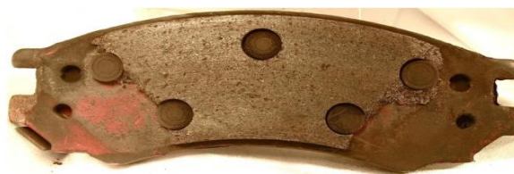
Slika 8: Tarna korozija automobilske kočnice [27]
