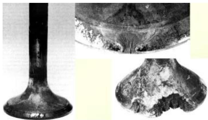
Elektrokemijska korozija predstavlja reduksijsko-oksidacijsku reakciju između metala i elektrolita. Rezultat je hrđanje osnovnog materijala te pojava oksida osnovnog materijala i soli. Rasprostranjenost elektrokemijske korozije je neupitna, jer su njoj izložene sve metalne konstrukcije koje imaju korozivno pristupačan okoliš, odnosno koje se nalaze u vlažnoj sredini. Svaki oblik korozije opisan sljedećom potpoglavlju predstavlja elektrokemijsku koroziju. [12, 13]
