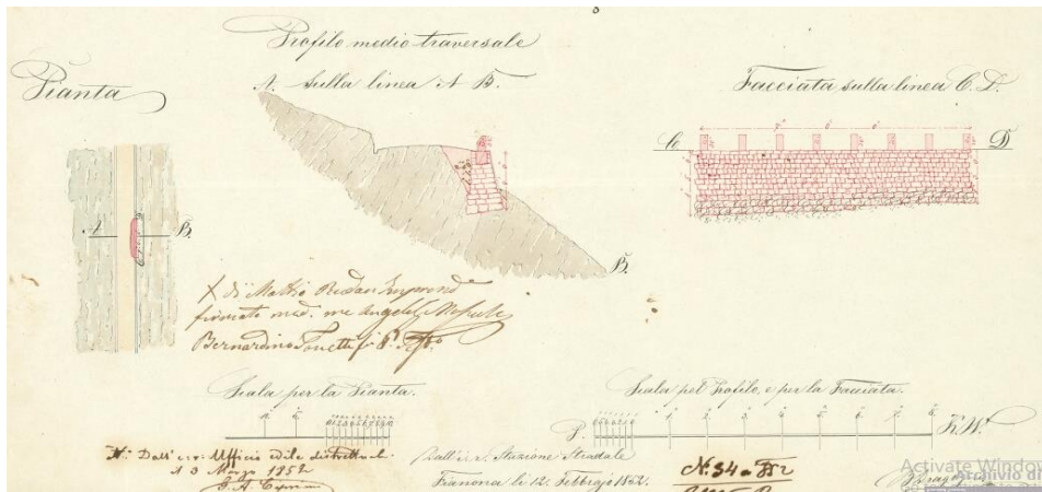
Slika 11. Plan dionice kraljevske ceste do katastarske općine Martina, s profilom i planom dijela urušenog zida. (Izvor: Archivio di Stato di Trieste; Catasti di Trieste, http://www.catasti.archivodistatotrieste.it/Divenire/document.htm?idUa=10654205&idDoc=10663851&first=0&last=0 , posjet: 10.10.2021)
