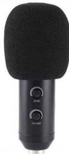
Slika 4. Primjer mikrofona sa spužvicom (Izvor: https://qph.cf2.quoracdn.net/main-qimg-8b06c24b76d5920a2b663004de08db93-lq )
