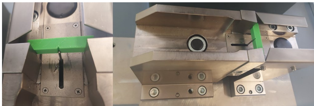
Slika 37. Postavljanje ispitnih epruveta u bat
