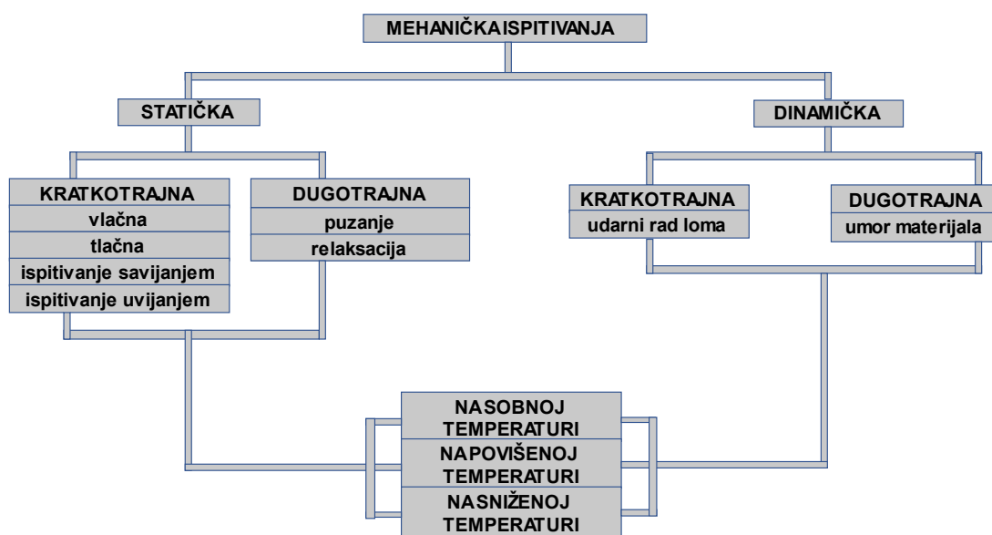
Slika 10. Uvjeti ispitivanja mehaničkih svojstava materijala [15]
