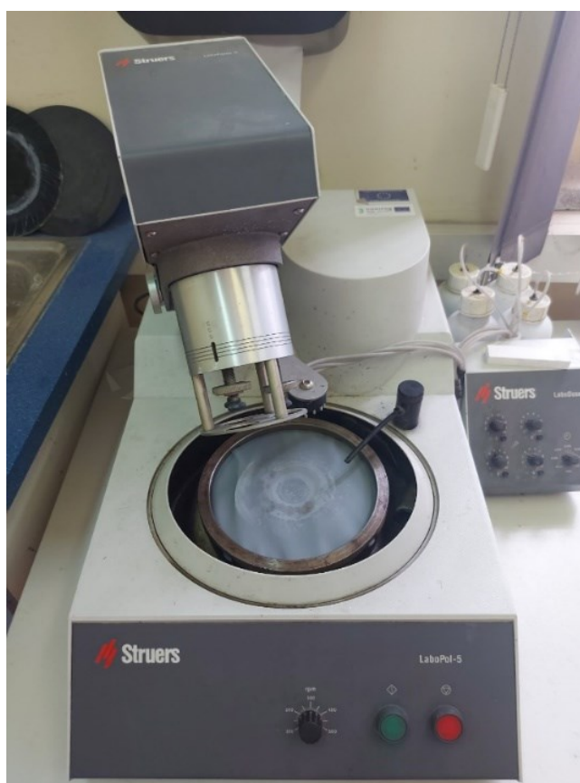
Slika 30. Uređaj za brušenje i poliranje ispitnih epruveta STRUERS LABOPOL-5
