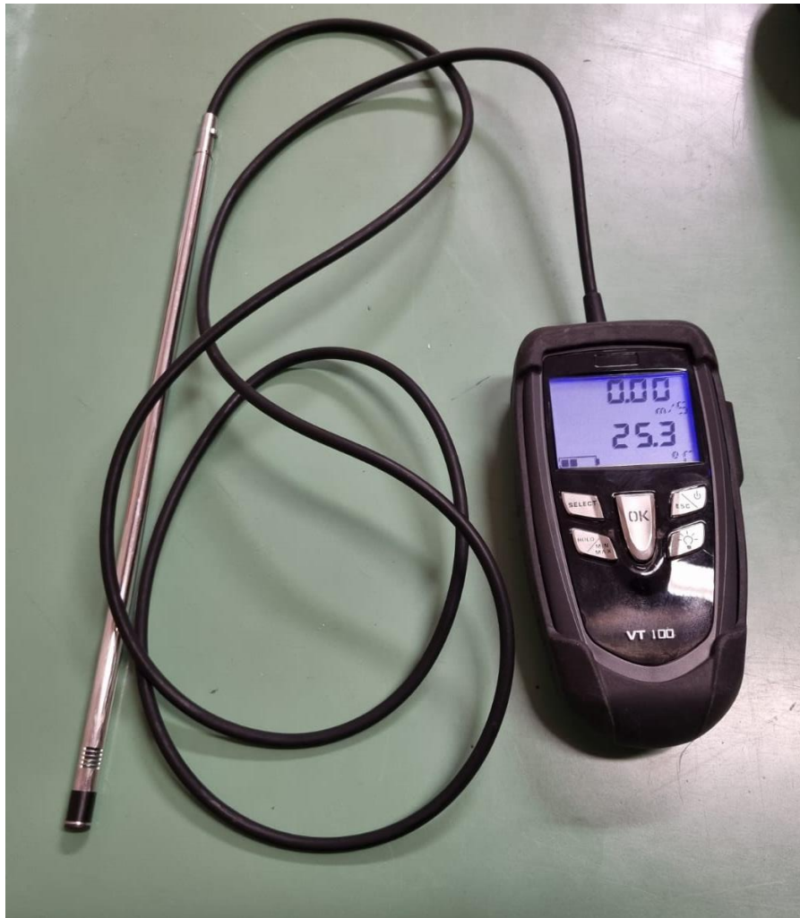
Slika 7. Mjerni instrument strujanja zraka – Anemometar KIMO tip VT 110
