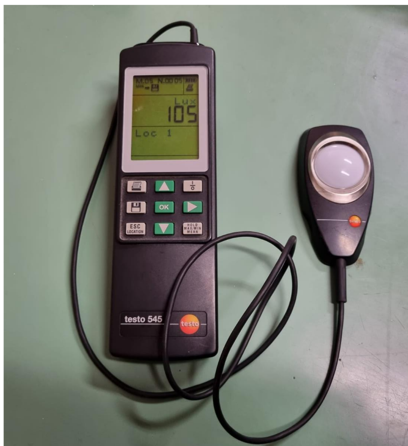
Slika 2. Mjerni instrument osvjetljenosti – Luksmetar testo 545
