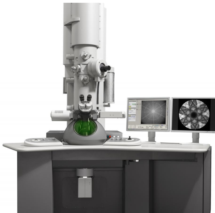
Slika 19: Prikaz TEM elektronskog mikroskopa Tecnai G2-30
