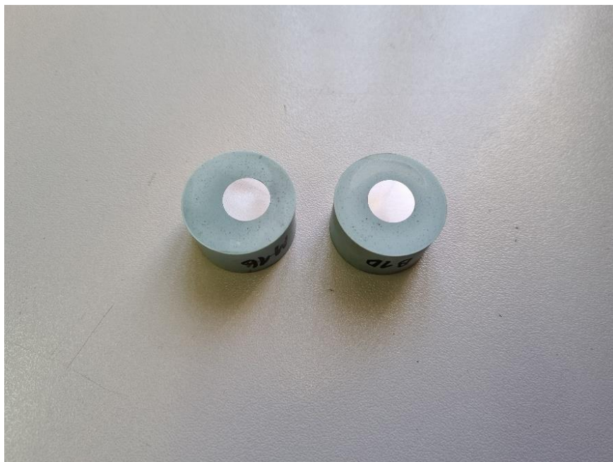
Slika 32: Fotografija uzorka nakon brušenja i poliranja
