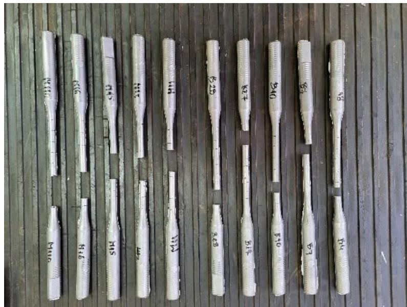
Slika 25: Testne epruvete nanokompozita nakon vlačnog testa
