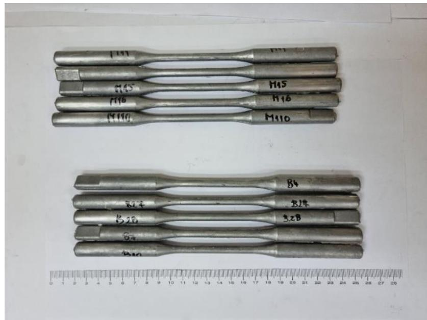
Slika 21: Testne epruvete nanokompozita
