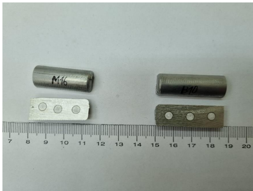
Slika 39: Prikaz uzorka nakon testiranja GDS uređajem
