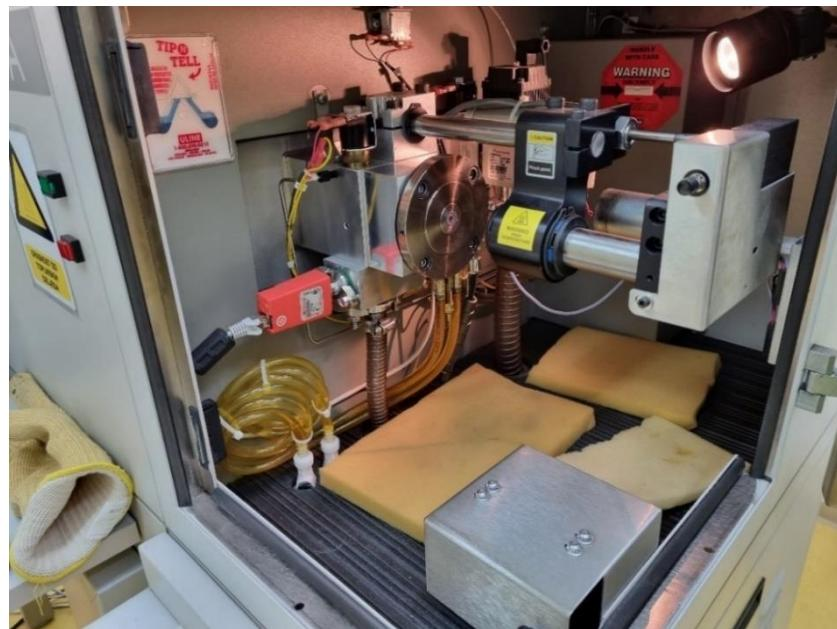
Slika 38: Unutrašnjost GDS uređaja Leco tip 500A
