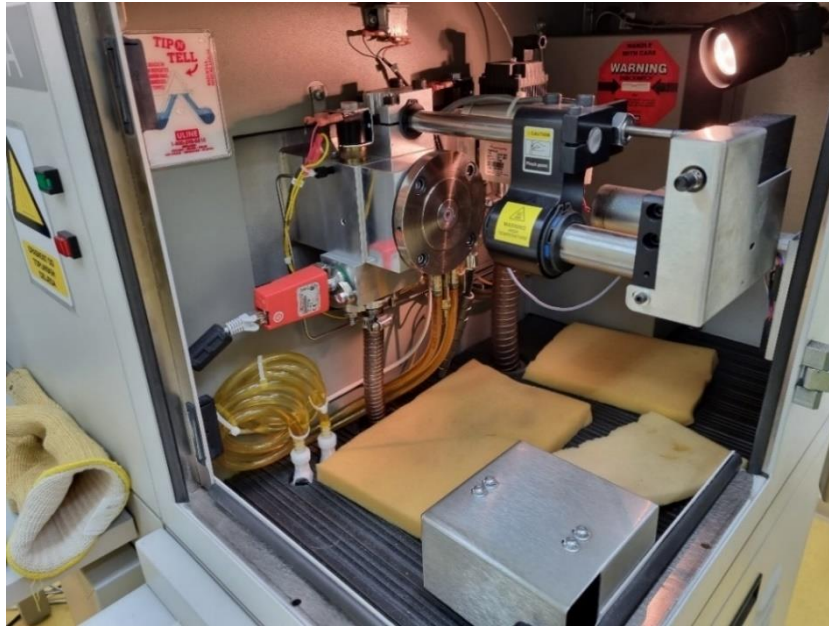
Slika 38: Unutrašnjost GDS uređaja Leco tip 500A
