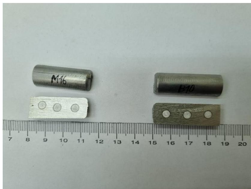
Slika 39: Prikaz uzorka nakon testiranja GDS uređajem
