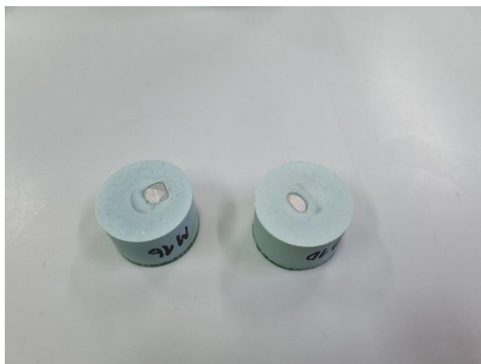
Slika 30: Prikaz uzoraka u smoli nakon sušenja
