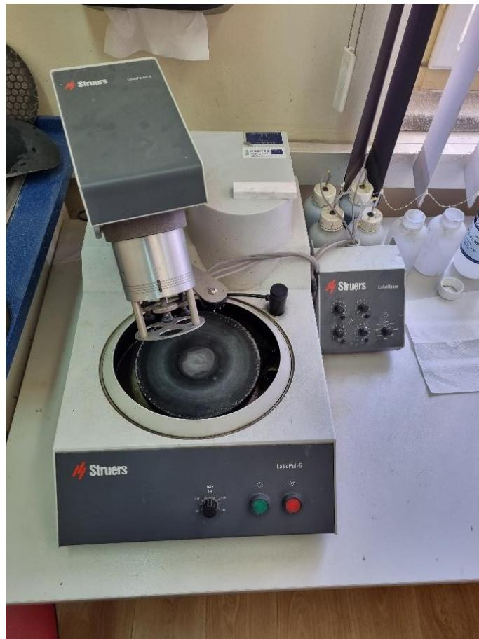
Slika 31: Struers Labopol - 5 uređaj za brušenje i poliranje
