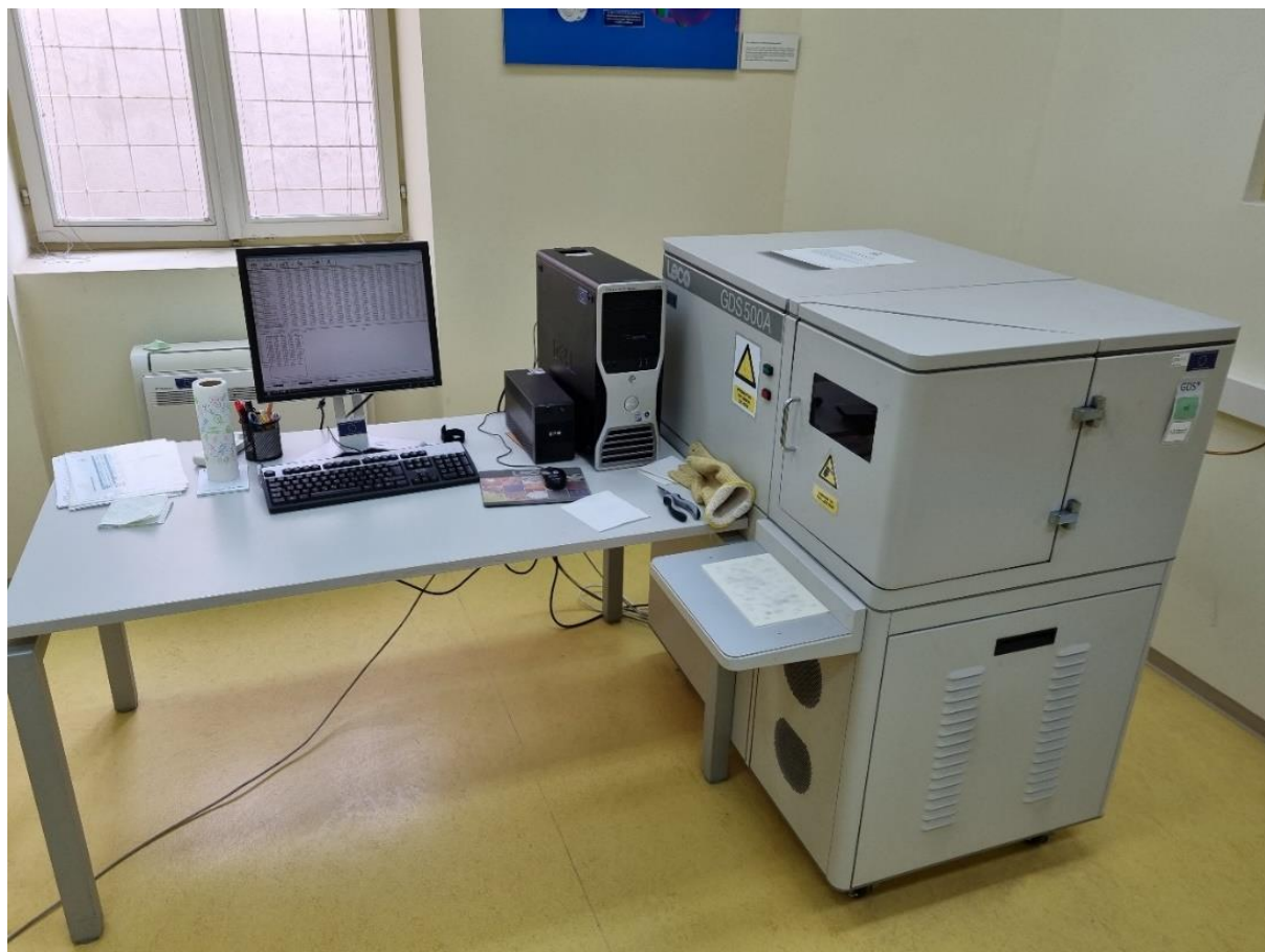
Slika 37: Radna stanica GDS optičkog emisijskog spektrometra Leco tip 500A
