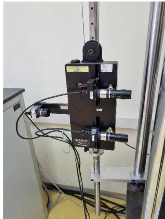
Slika 23: Laserski ekstenzometar ME 53 – 250 i digitalna kamera
