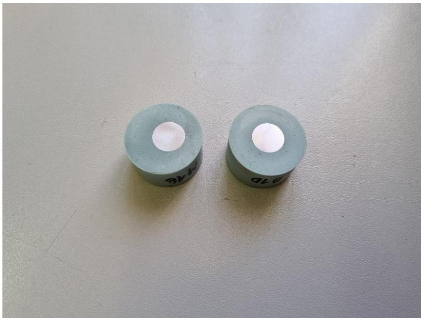
Slika 32: Fotografija uzorka nakon brušenja i poliranja
