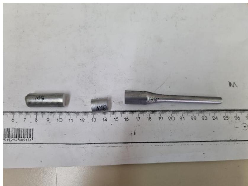
Slika 28: Uzorak nakon rezanja
