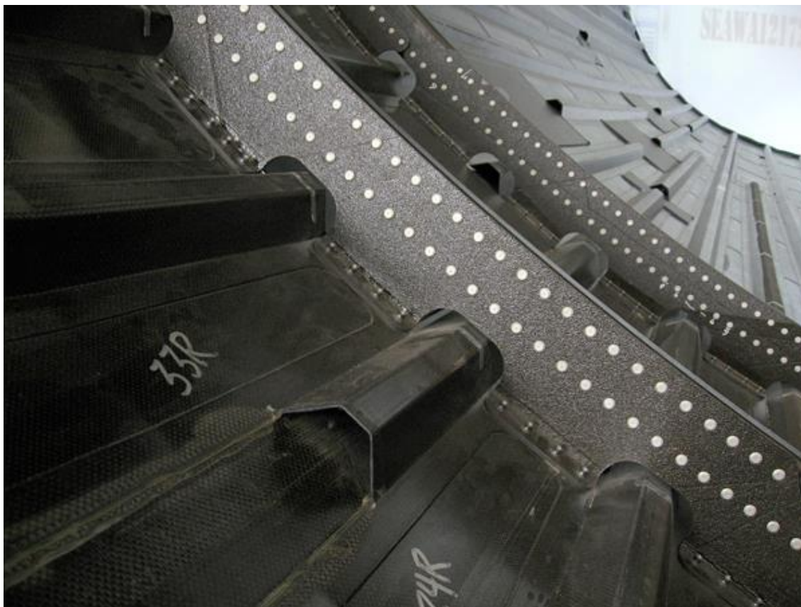
Slika 5: Boeing 787 trup, napravljen od plastičnog kompozita
