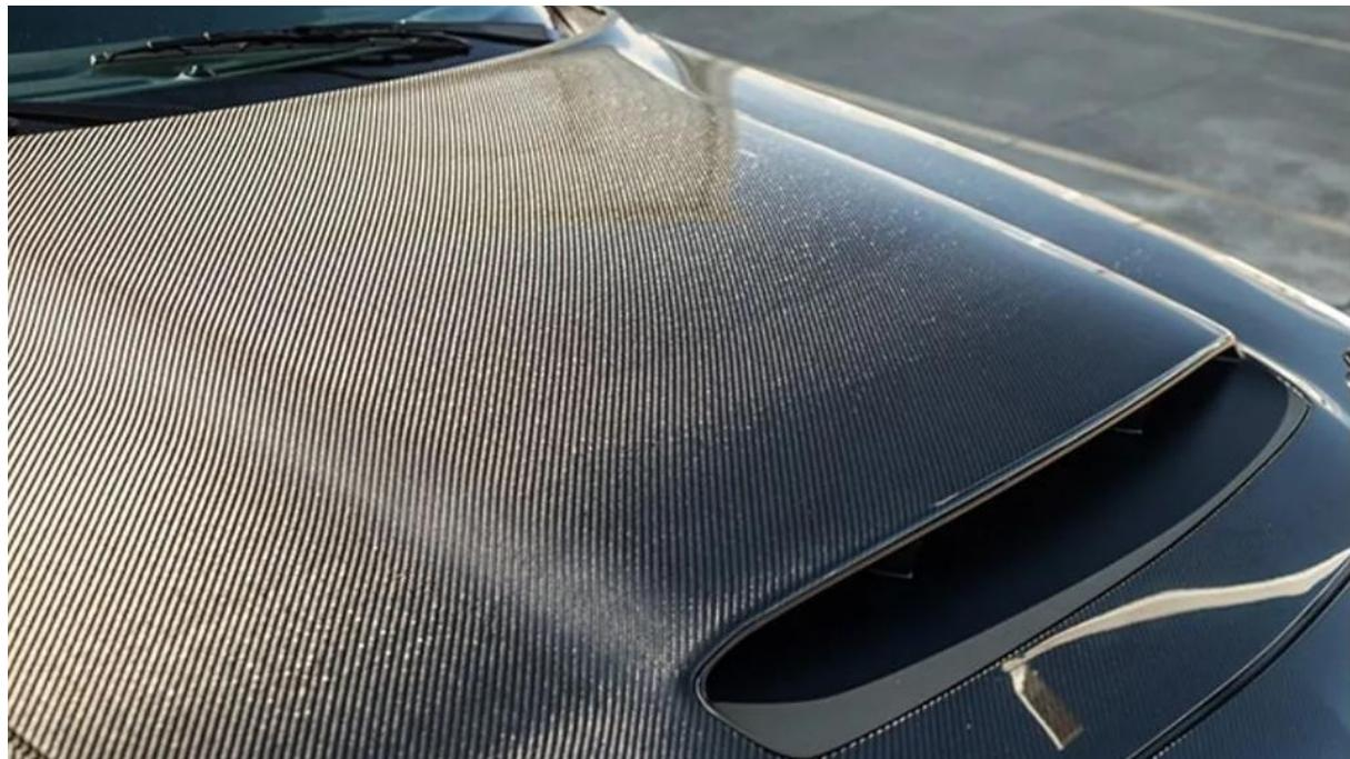
Slika 11: Prikaz poklopca motora napravljenog kompozita s ugljikovim vlaknima
