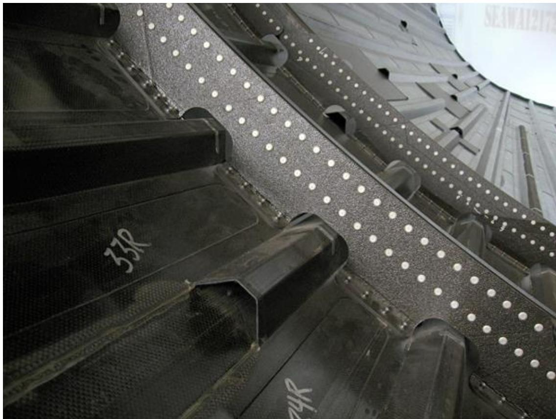
Slika 5: Boeing 787 trup, napravljen od plastičnog kompozita
