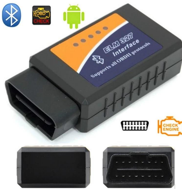
Slika 27: Globalni dijagnostički uređaj „ELM327“
