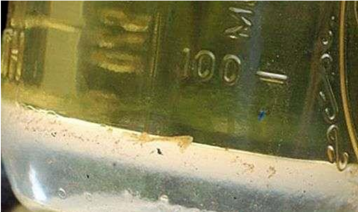
Slika 21: Nakupljena voda na dnu rezervoara goriva
