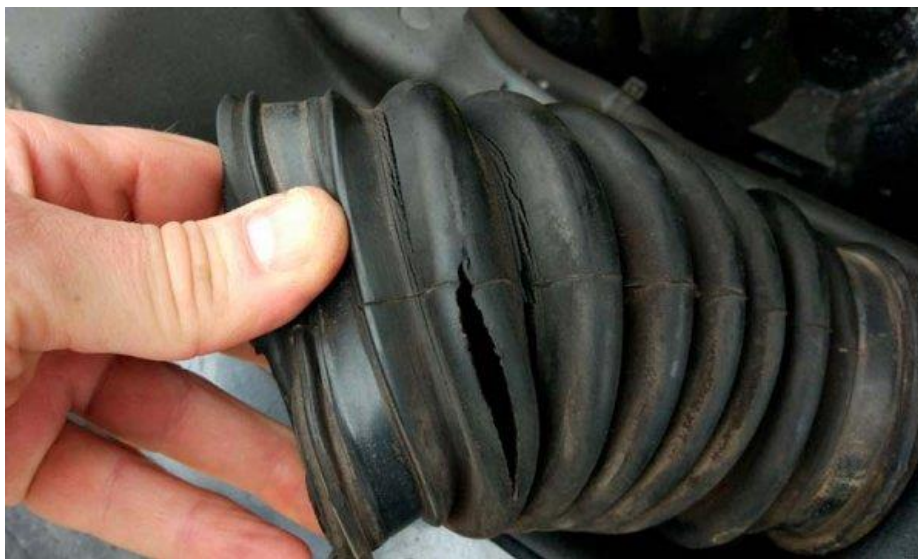
Slika 19: Prikaz puknuća vakuumske cijevi
