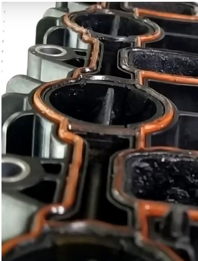
Slika 43: Prikaz pravilnog položaja potpuno otvorenih zaklopki
