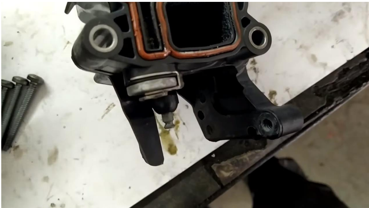
Slika 45: Mjesto pričvršćenja elektromotora sa usisnom granom
