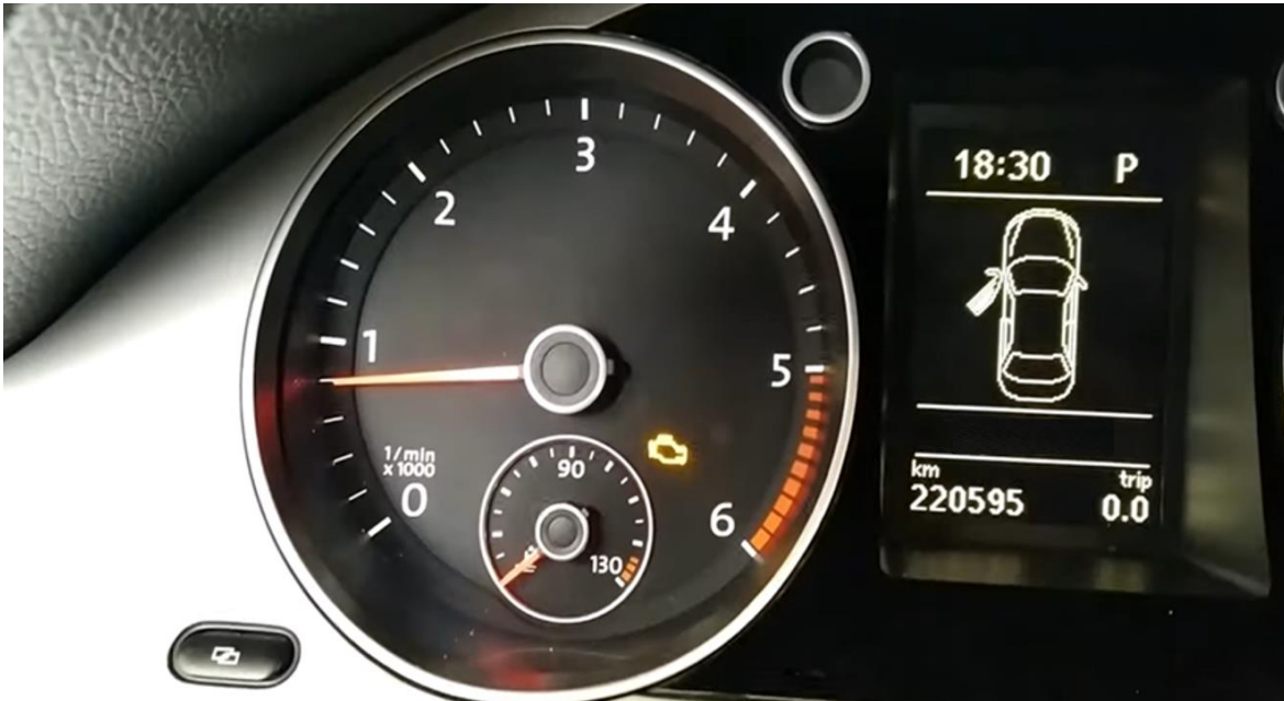
Slika 30: Kontrolna tabla sa upaljenom lampicom greške motora
