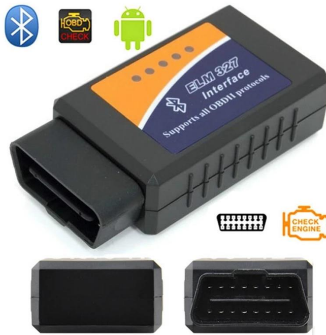
Slika 27: Globalni dijagnostički uređaj „ELM327“
