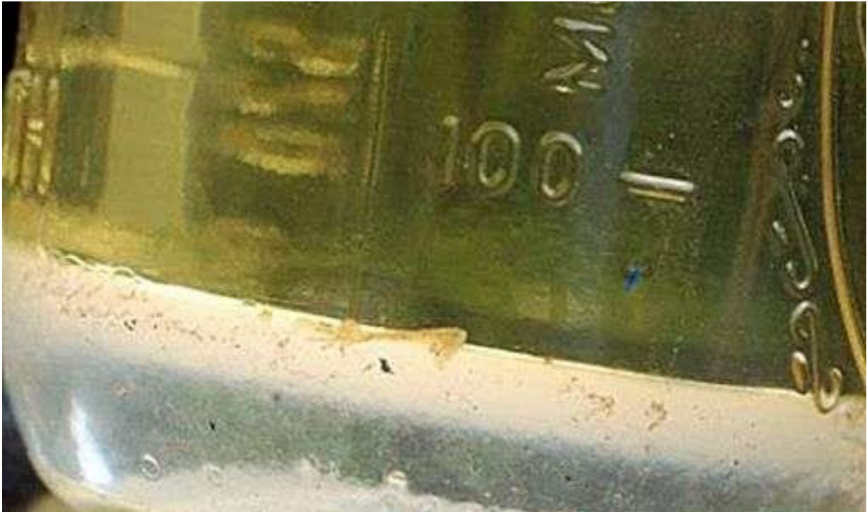
Slika 21: Nakupljena voda na dnu rezervoara goriva
