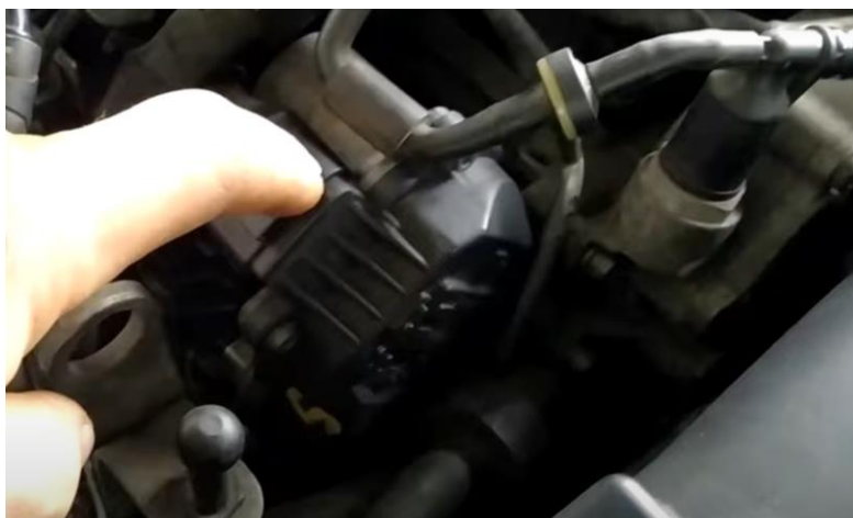
Slika 37: Elektromotor unutar kojeg se nalazi senzor položaja
