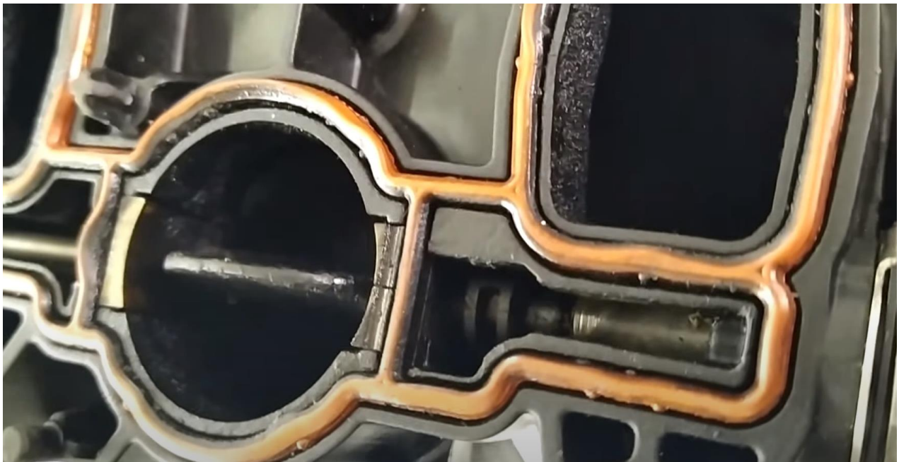
Slika 48: Prikaz ispravnog položaja zaklopki (kut od 90°)
