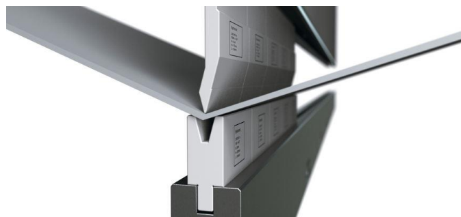
Slika 15 Zračno savijanje lima; izvor: https://www.laser-ing.hr/wp-content/uploads/2022/07/savijanje-lima.jpg
