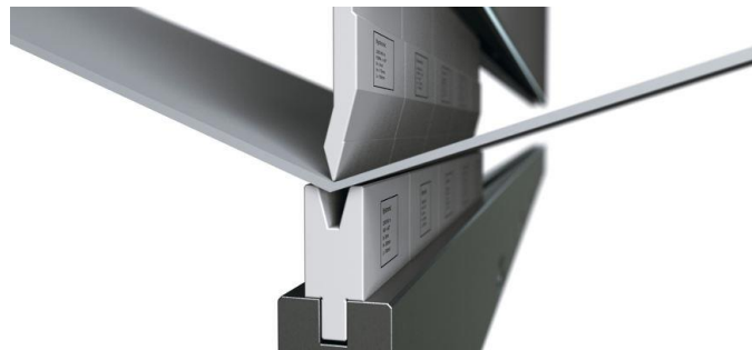
Slika 15 Zračno savijanje lima; izvor: https://www.laser-ing.hr/wp-content/uploads/2022/07/savijanje-lima.jpg
