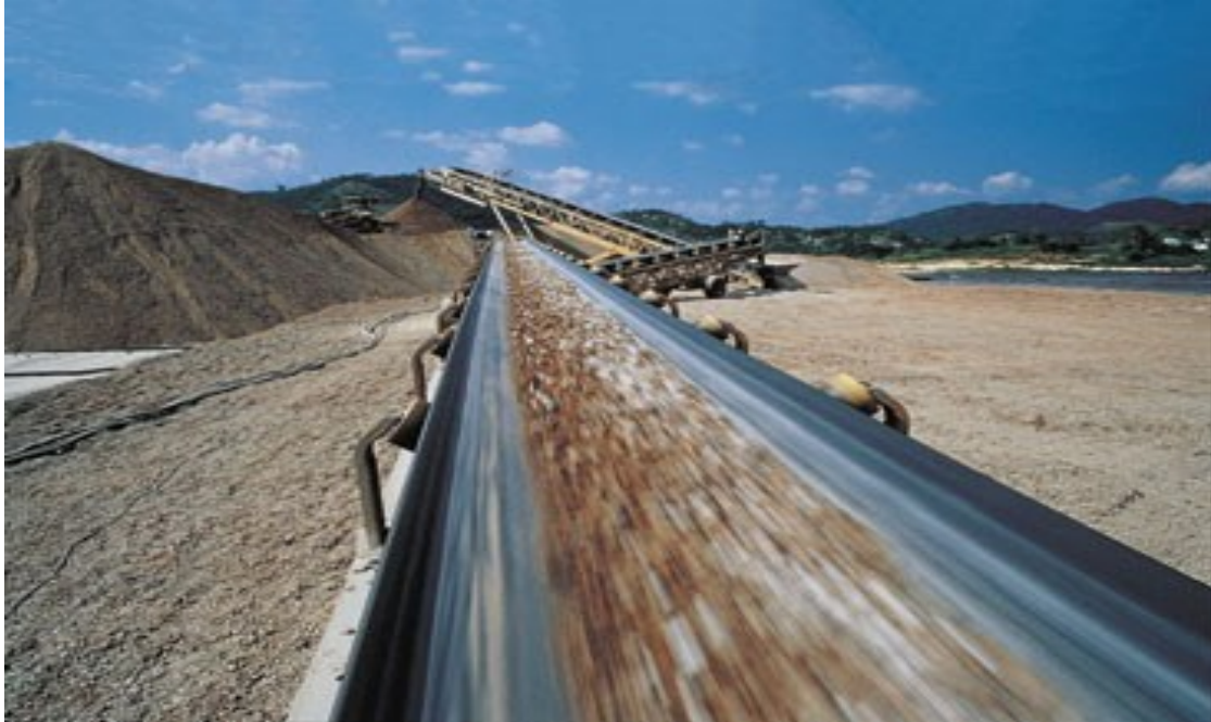
Slika 3. Trakasti transporter u radu
