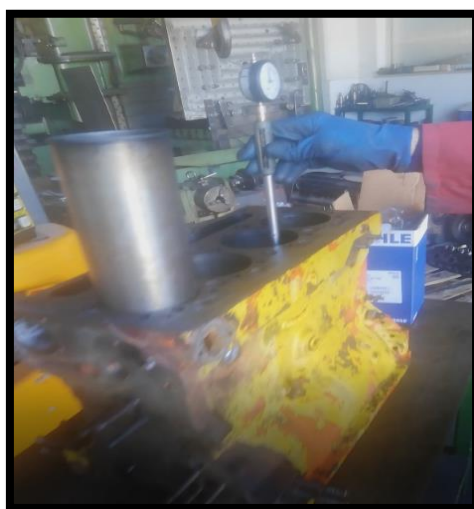
Slika 27.: Mjerenje preklopa košuljice i provrta bloka motora
