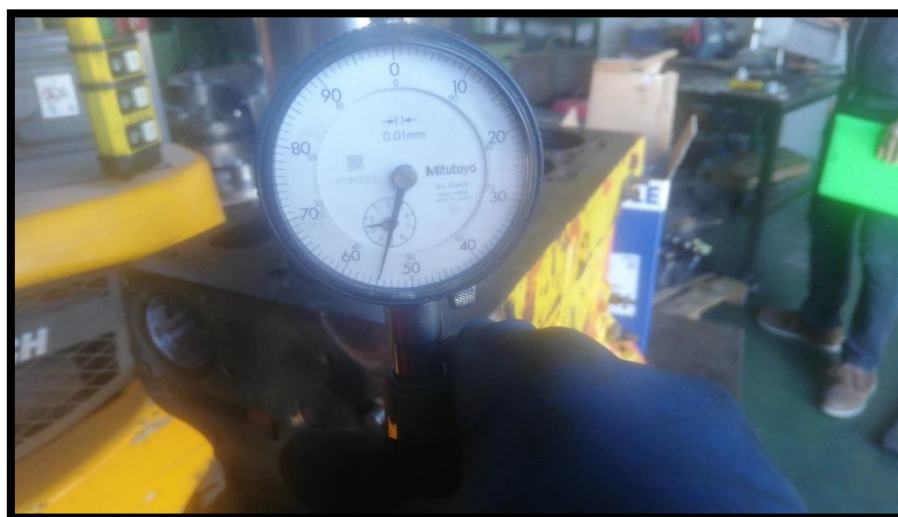
Slika 23.: Izmjereno treće odstupanje istrošenosti cilindra 0,45 mm
