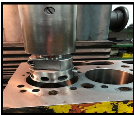
Slika 31.: Glava tokarilice i nož
