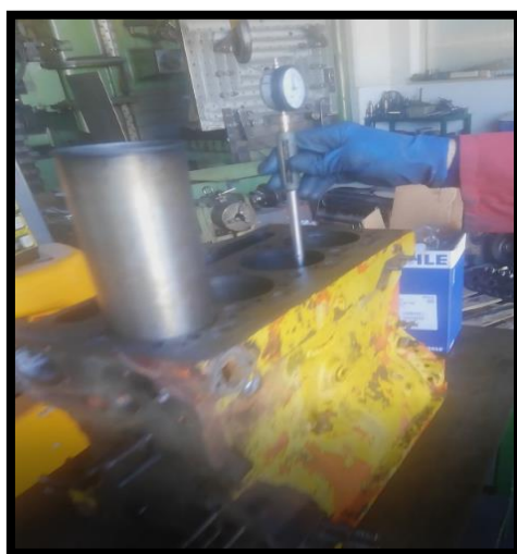
Slika 27.: Mjerenje preklopa košuljice i provrta bloka motora
