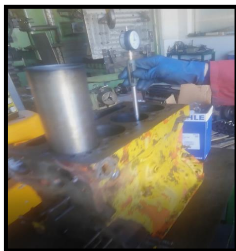
Slika 27.: Mjerenje preklopa košuljice i provrta bloka motora
