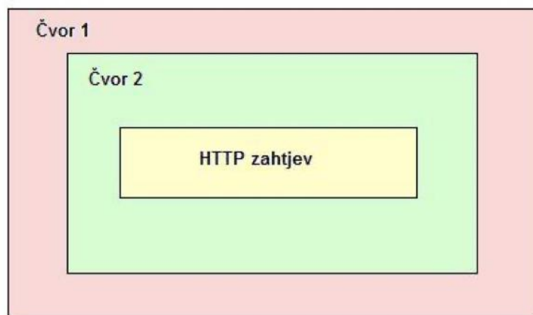
Slika 13. Struktura poruke sa HTTP zahtjevom.
