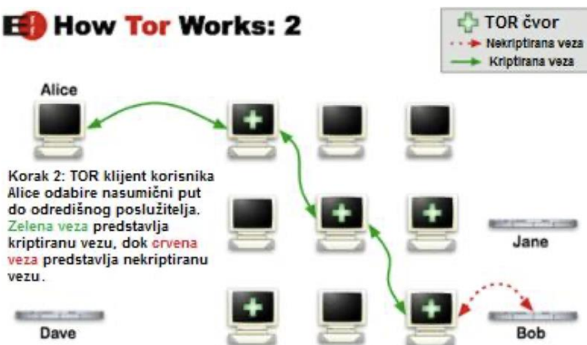
Slika 18. Način rada TOR-a, 2. korak (cis.hr, 2012.).
