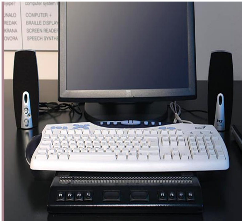
Slika 4. Braillev redak kod stolnog računala (izvor: https://www.tifloloskimuzej.hr/hr/stalni-postav/ukorak-s-vremenom/predmet-brailleov-redak )
