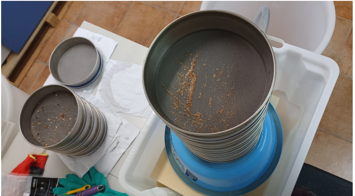
Slika 4-prosijavanje uzorka tretiranog H 2 O 2 -om
