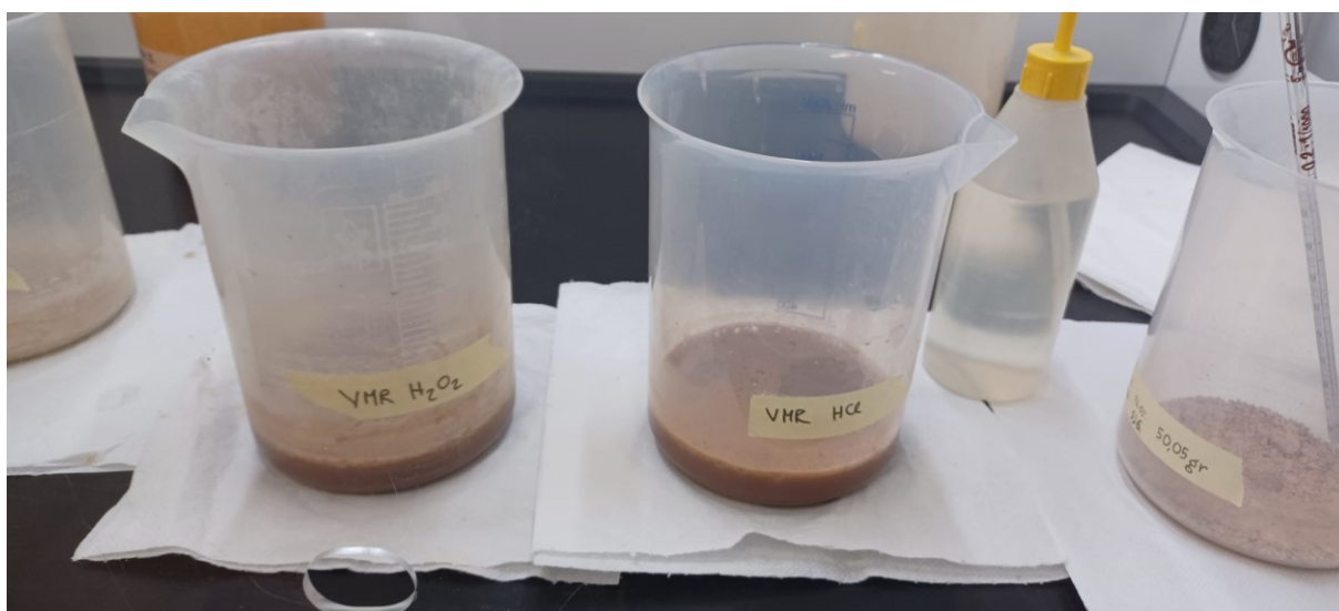
Slika 2-Uzorci tla SJ 4 istočnog profila sonde II u digestoru nakon tretiranja sa HCl i H 2 O 2
