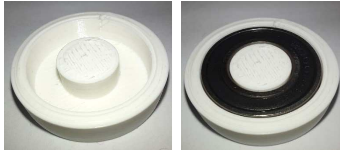
Slika 5.22 Pokusna komponenta za ispitivanje optimalne zračnosti utora planetarnog zupčanika i osovine nosača sa pripadajućim ležajem
