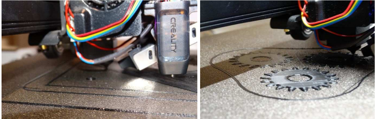
Slika 5.17 Prikaz početka postupka ispisa stražnjeg poklopca i planetarnih zupčanika
