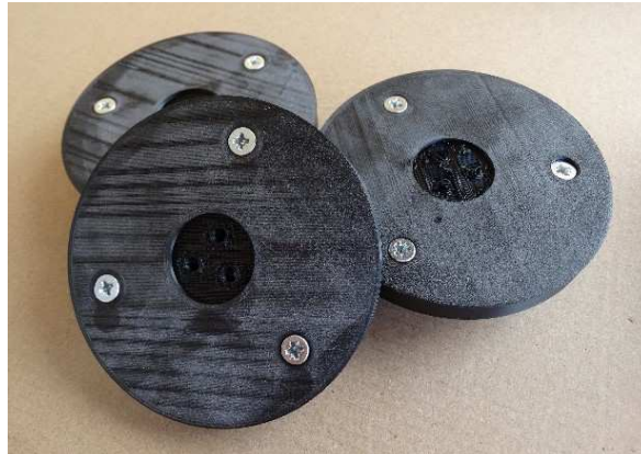
Slika 5.24 Prikaz vijaka u provrtima osovina na nosačima planeta
