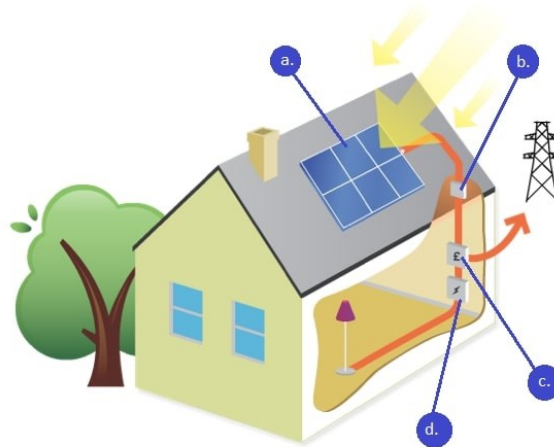
Slika 7. Osnovne komponente fotonaponske elektrane
