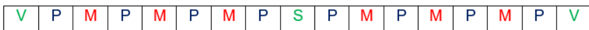
Slika 24. Redoslijed popravaka i pregleda jednog ciklusa održavanja; V(veliki pregled), M(mali pregled), S(srednji pregled) i P(preventivni pregled)
