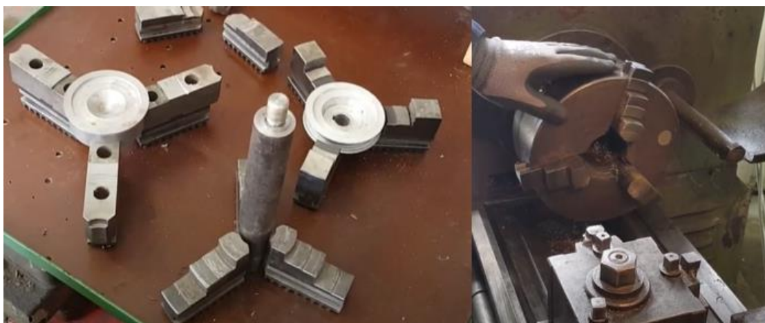
Slika 30. Prikaz steznih čeljusti i postavljene odgovarajuće čeljusti za određeni materijal u steznu glavu
