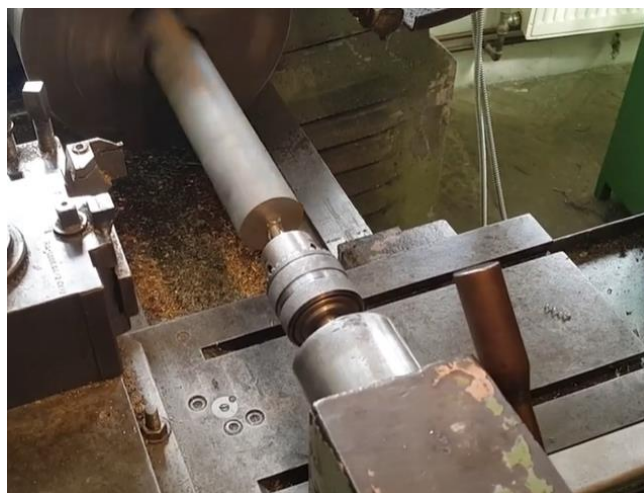
Slika 32. Prikaz zabušivanja obratka
