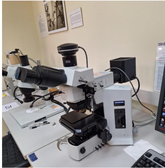
Slika 10: Metalografski mikroskop BX51 tvrtke OLYMPUS
