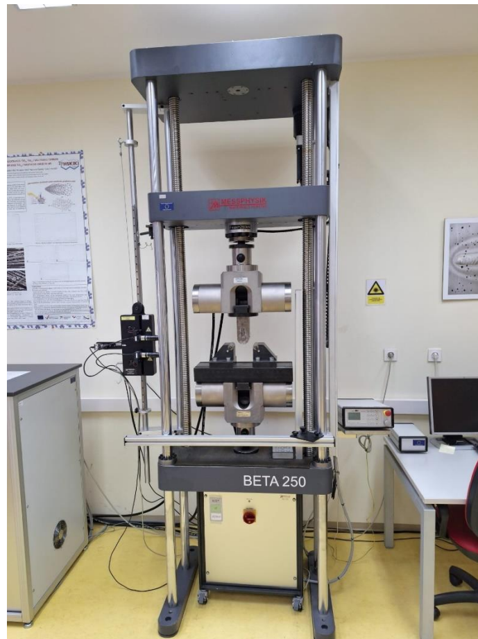
Slika 14: Univerzalnoj statička kidalica BETA250, tvrtke Messphysik
