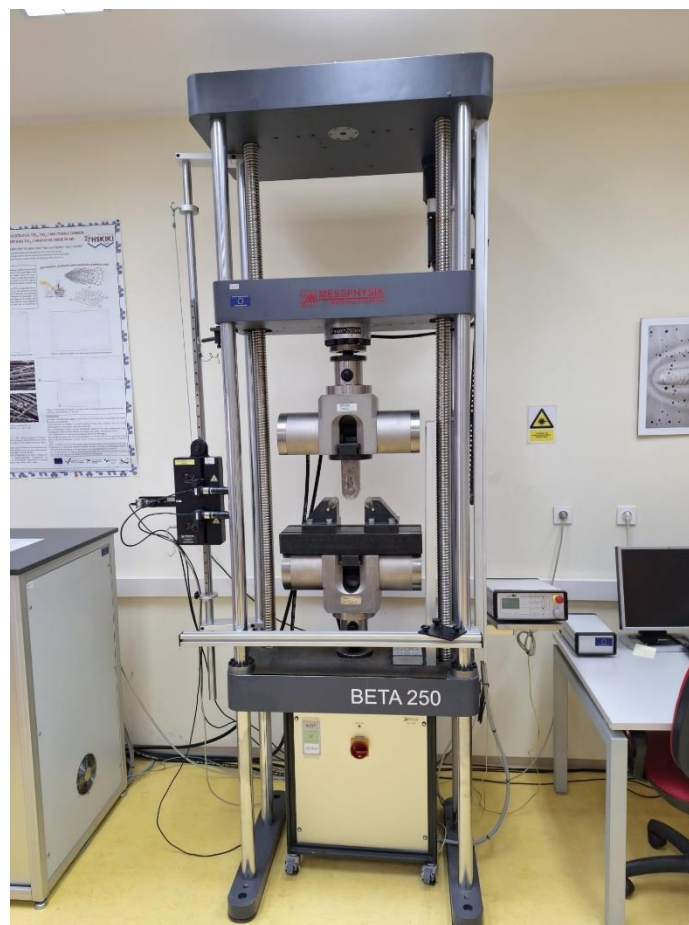
Slika 14: Univerzalnoj statička kidalica BETA250, tvrtke Messphysik
