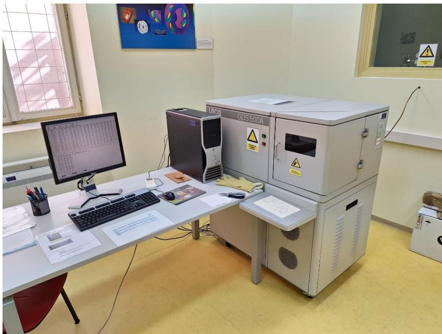
Slika 7: Optički emisijski spektrometar GDS500A LECO
