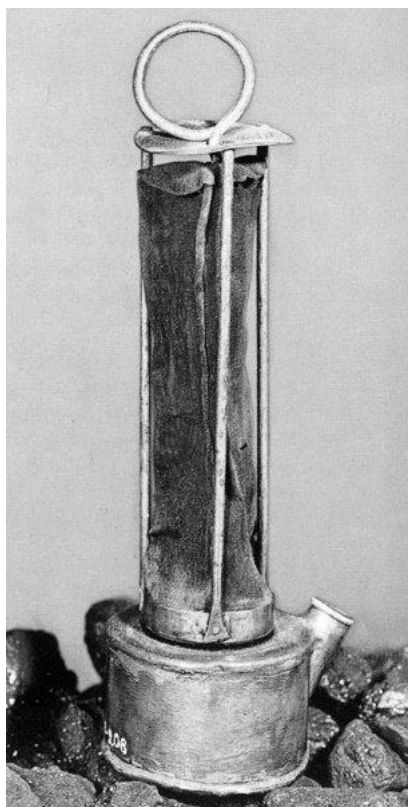
Slika 3. Sigurnosna svjetiljka H. Davyja (Izvor: https://www.enciklopedija.hr/natuknica.aspx?ID=14050 , 23. kolovoza 2023.)
