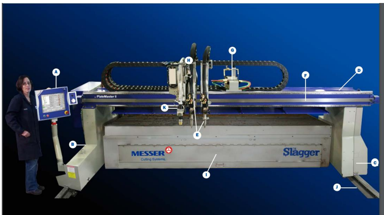
Slika 24: MESSER – cnc rezač plazmom
