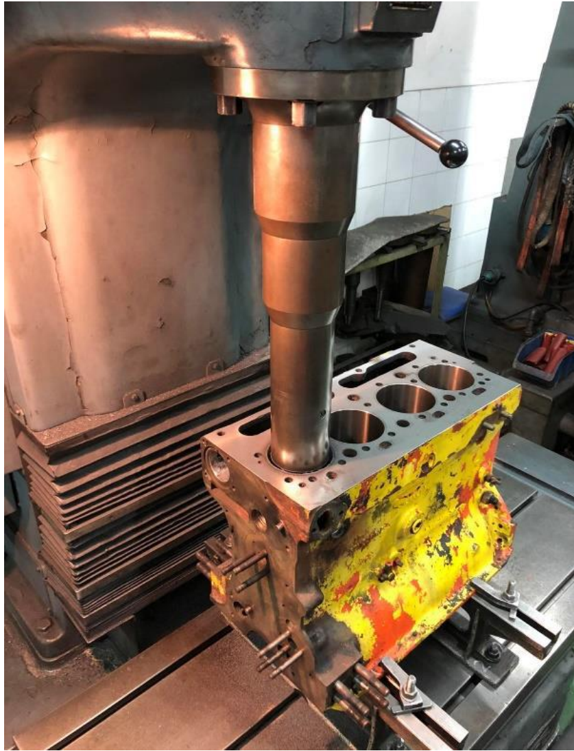
Slika 27. Spuštanje glave tokarilice u košuljicu cilindra.
