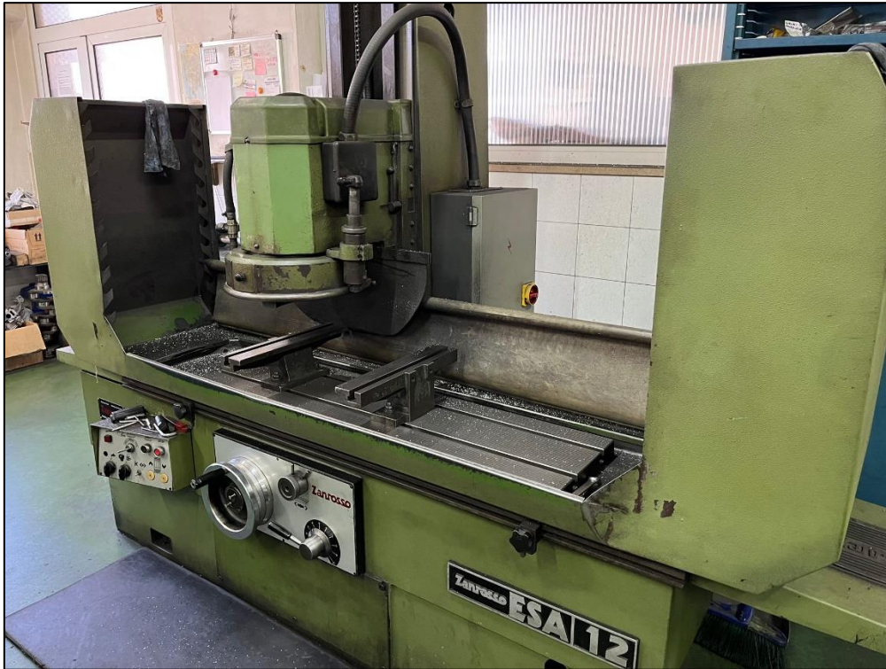
Slika 24. Stroj korišten za ravnanje bloka Zanrosso ESA 12.
