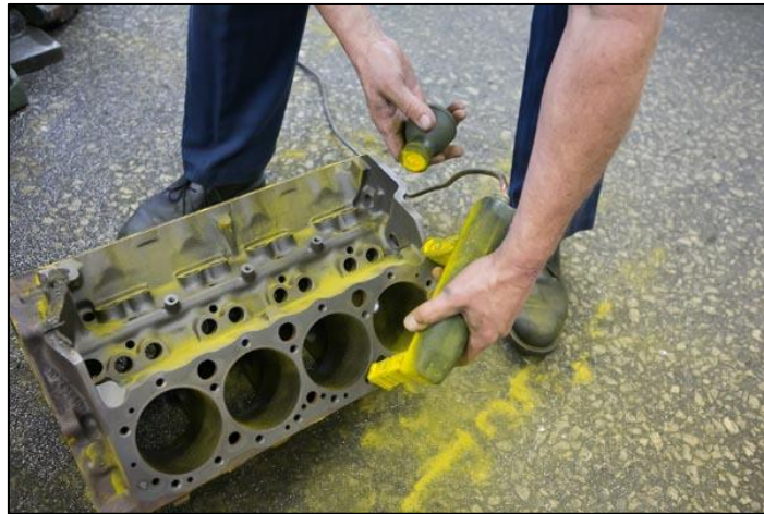
Slika 8. Praktičan primjer magnetne detekcije
