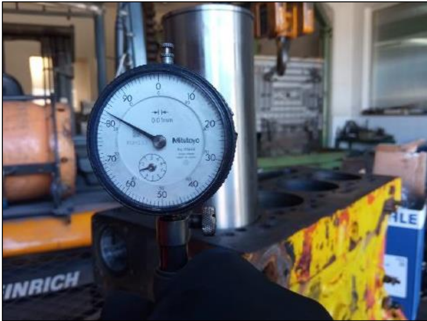
Slika 16. Prvo mjerenje odstupanja.
