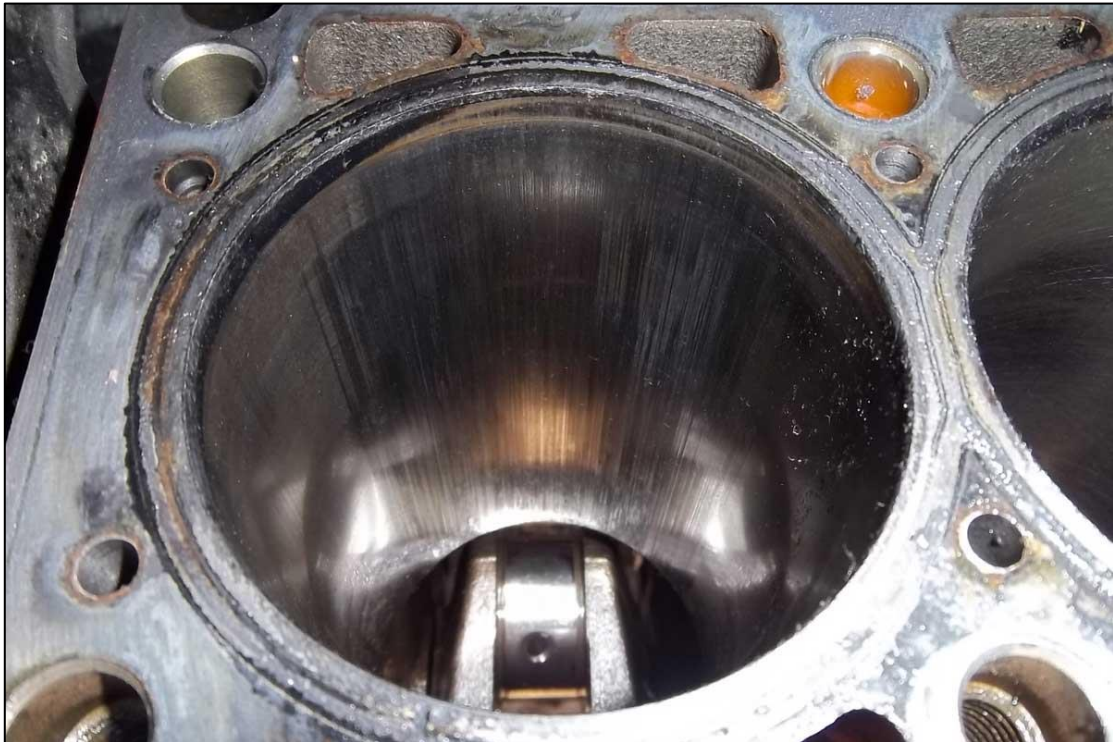
Slika 7. Vizualna inspekcija stanja cilindra
