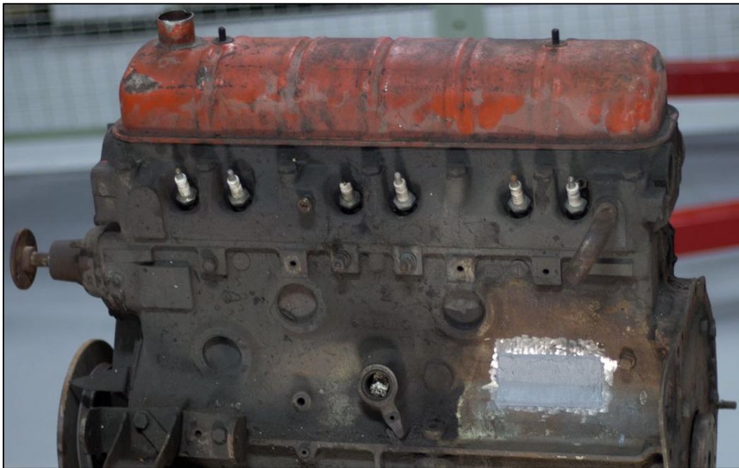
Slika 12. Primjer reparacija bloka motora metodom zavarivanja.
