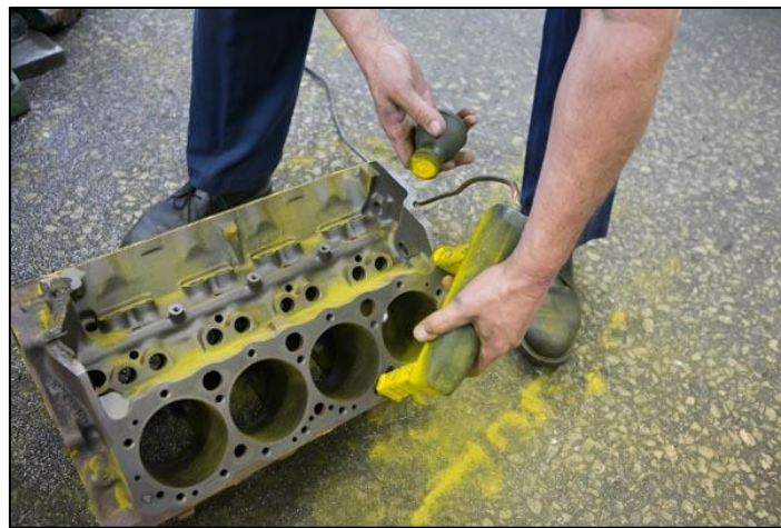
Slika 8. Praktičan primjer magnetne detekcije
