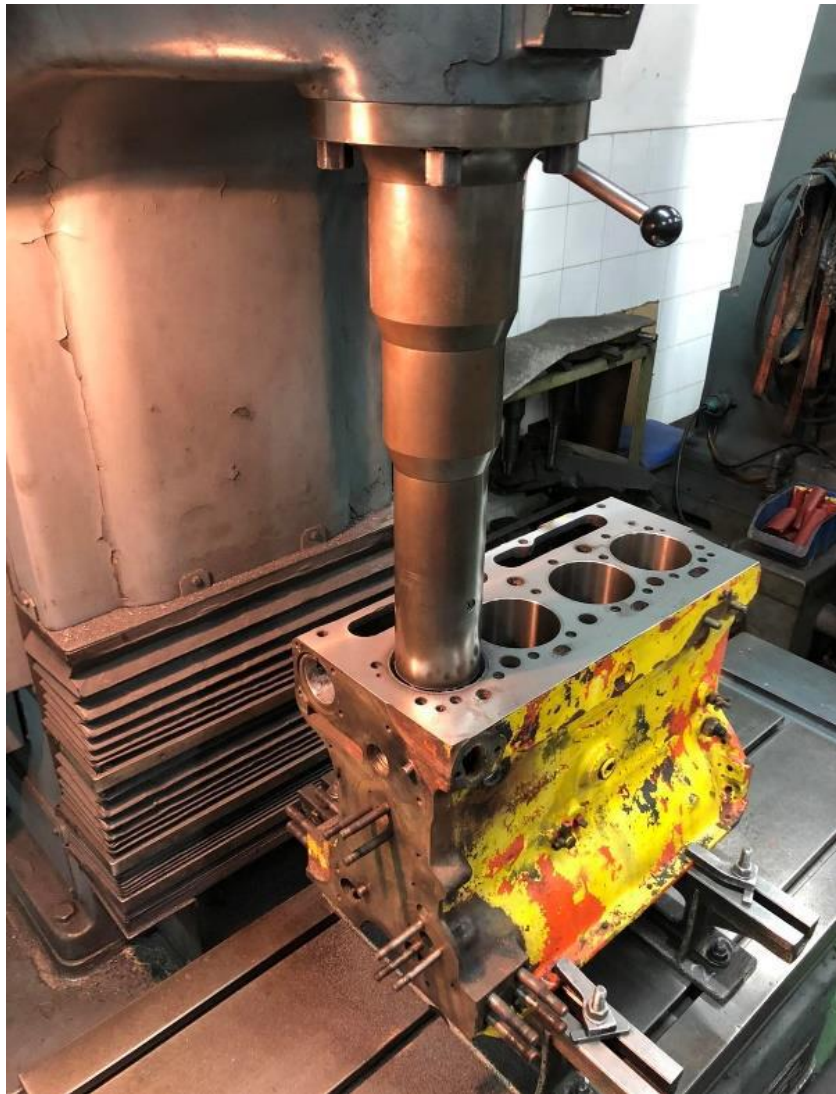
Slika 27. Spuštanje glave tokarilice u košuljicu cilindra.
