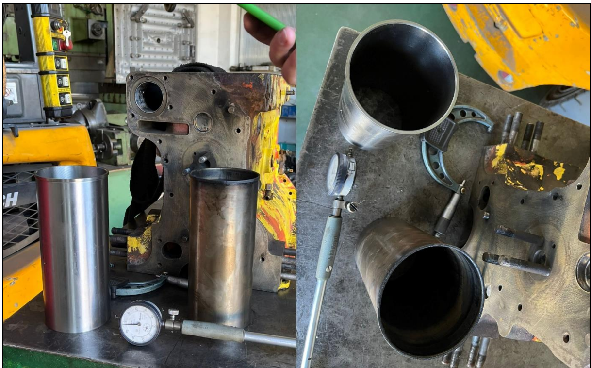
Slika 20. Prikaz razlike između stare i nove košuljice cilindra.
