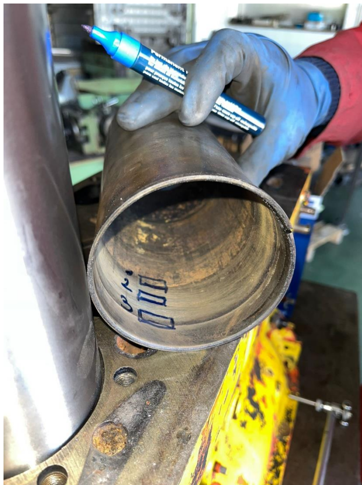
Slika 15. Izmjerena odstupanja košuljice
