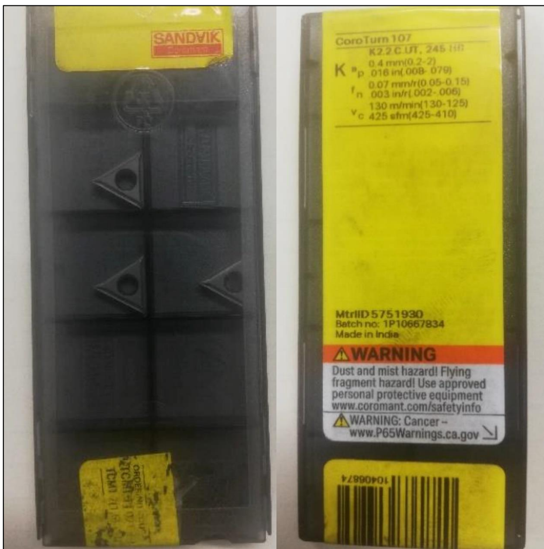
Slika 28. Noževi korišteni za obradu i njihovi parametri.
