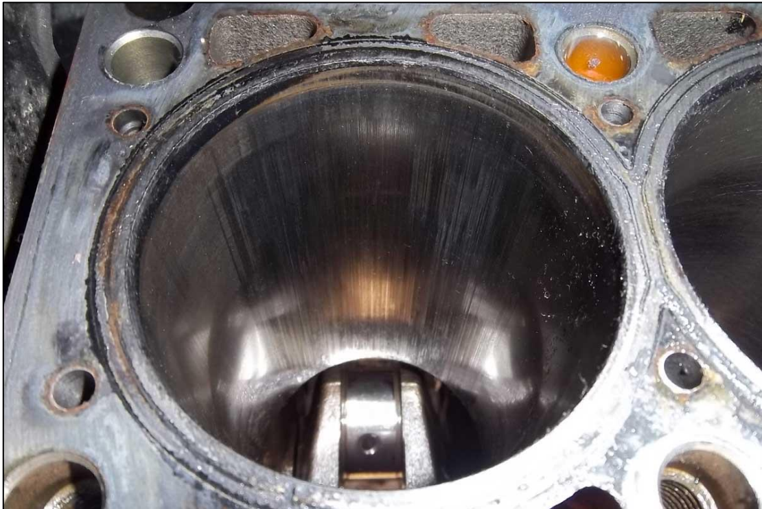
Slika 7. Vizualna inspekcija stanja cilindra
