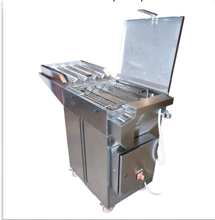
Slika 26. Prikaz kompletne pekarske friteze
