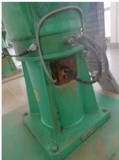
Slika 5.15 Mjerenje vibracija u smjeru V na položaju A CA 2 crpne stanice Gradole
