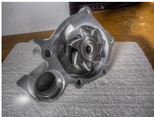
Slika 1. Unutrašnjost pumpe za vodu u automobilu
