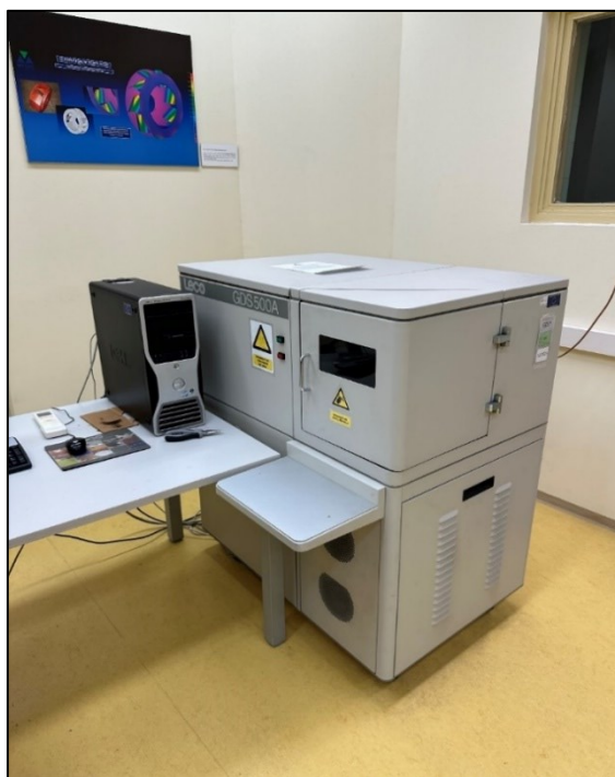
Slika 2. Spektrometar GDS500A tvrtke LECO.
