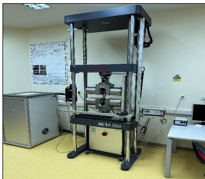
Slika 16. Statička kidalica BETA 250 tvrtke Messphysik.
