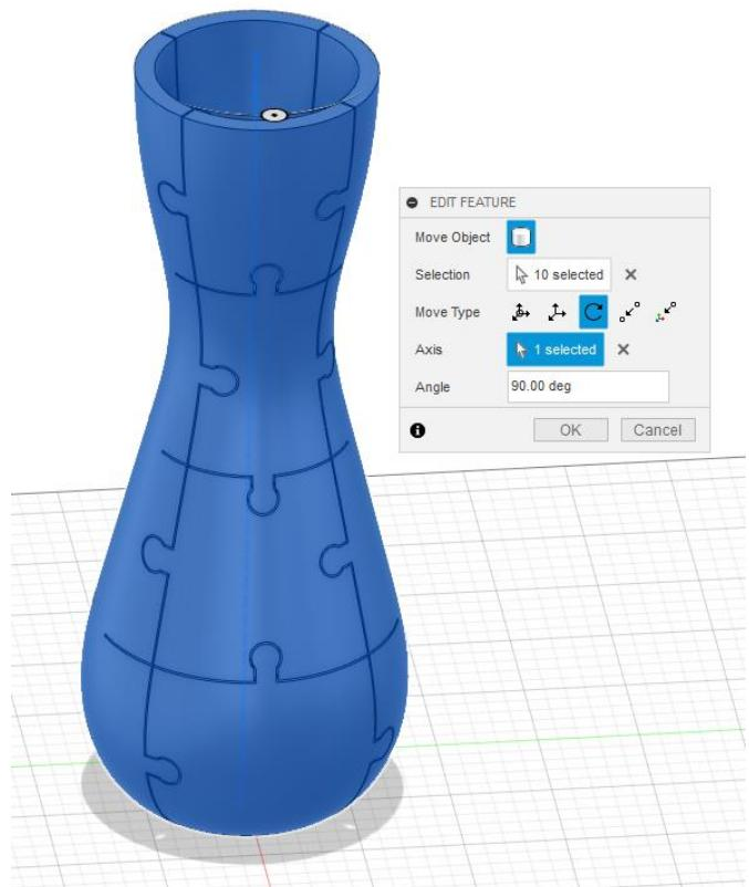
Slika 50. Rotiranje modela za 90 stupnjeva
