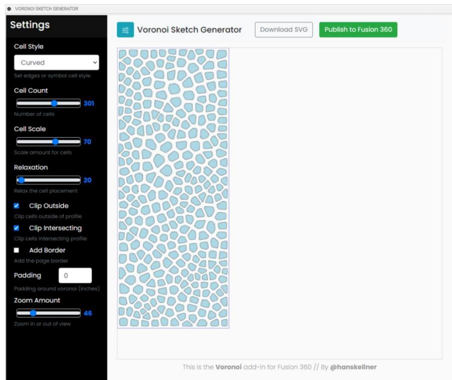
Slika 25. Uređivanje parametara u Voronoi Sketch Generatoru.
