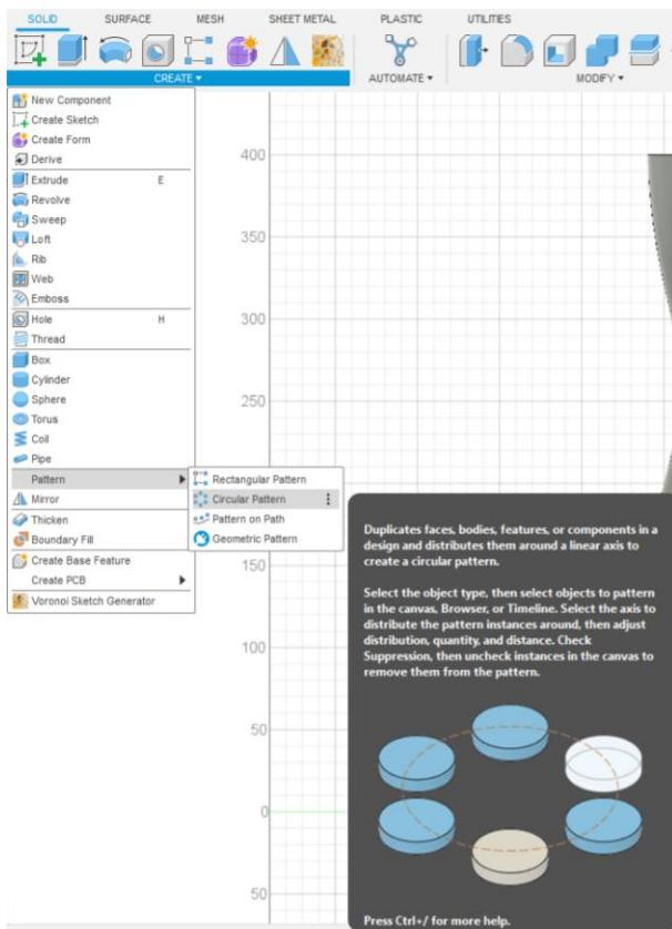
Slika 35. Circular Pattern alat za izradu kružnog uzorka
