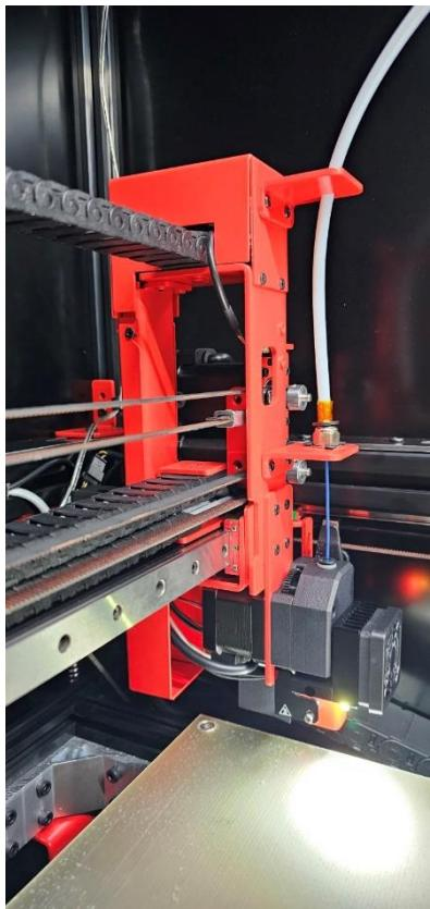
*Slika 6. 3D printer velikih volumenskih modela*
