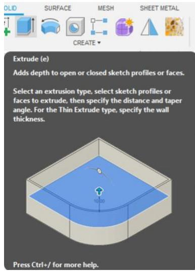
Slika 33. Extrude alat za izrezivanje/istiskivanje tijela iz skice
