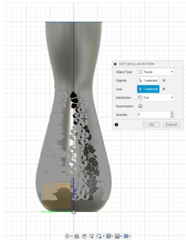
Slika 36. Izbornik Edit Circular Pattern za uređivanje parametara
