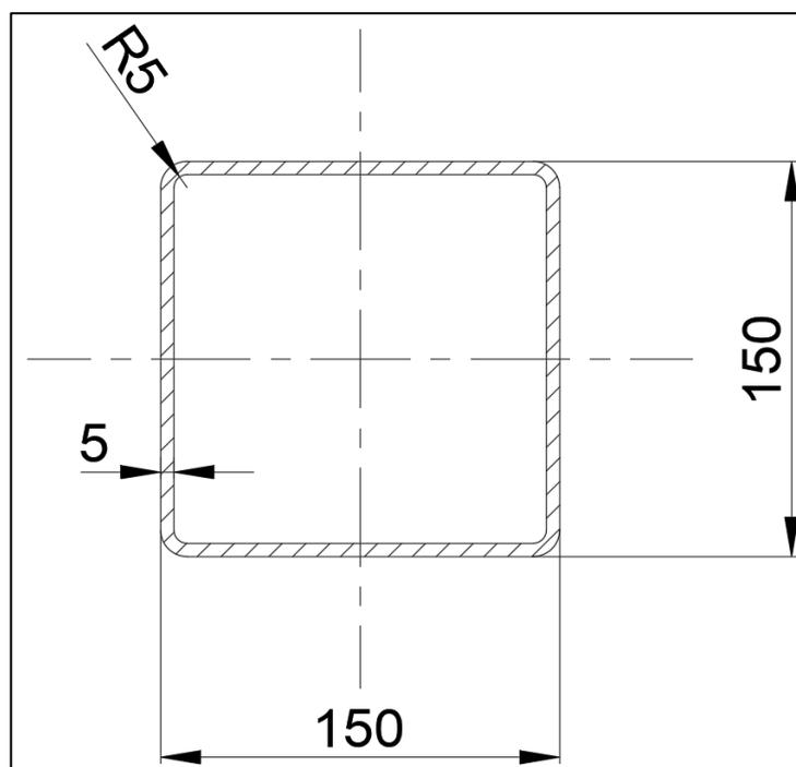
Slika 37. Poprečni presjek kvadratne cijevi konstrukcije dizala
