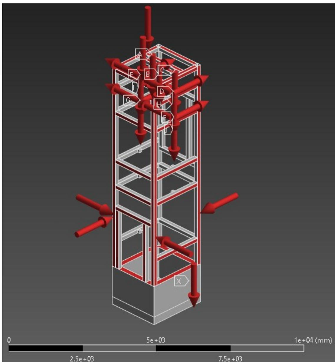
Slika 39. Skica rasporeda opterećenja u slučaju Bočni udari 1
