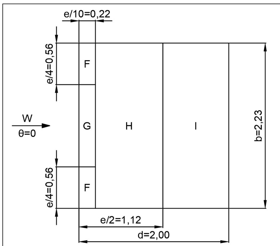
Slika 21. Pojednostavljeni prikaz krovne plohe kod W+Y i W-Y
