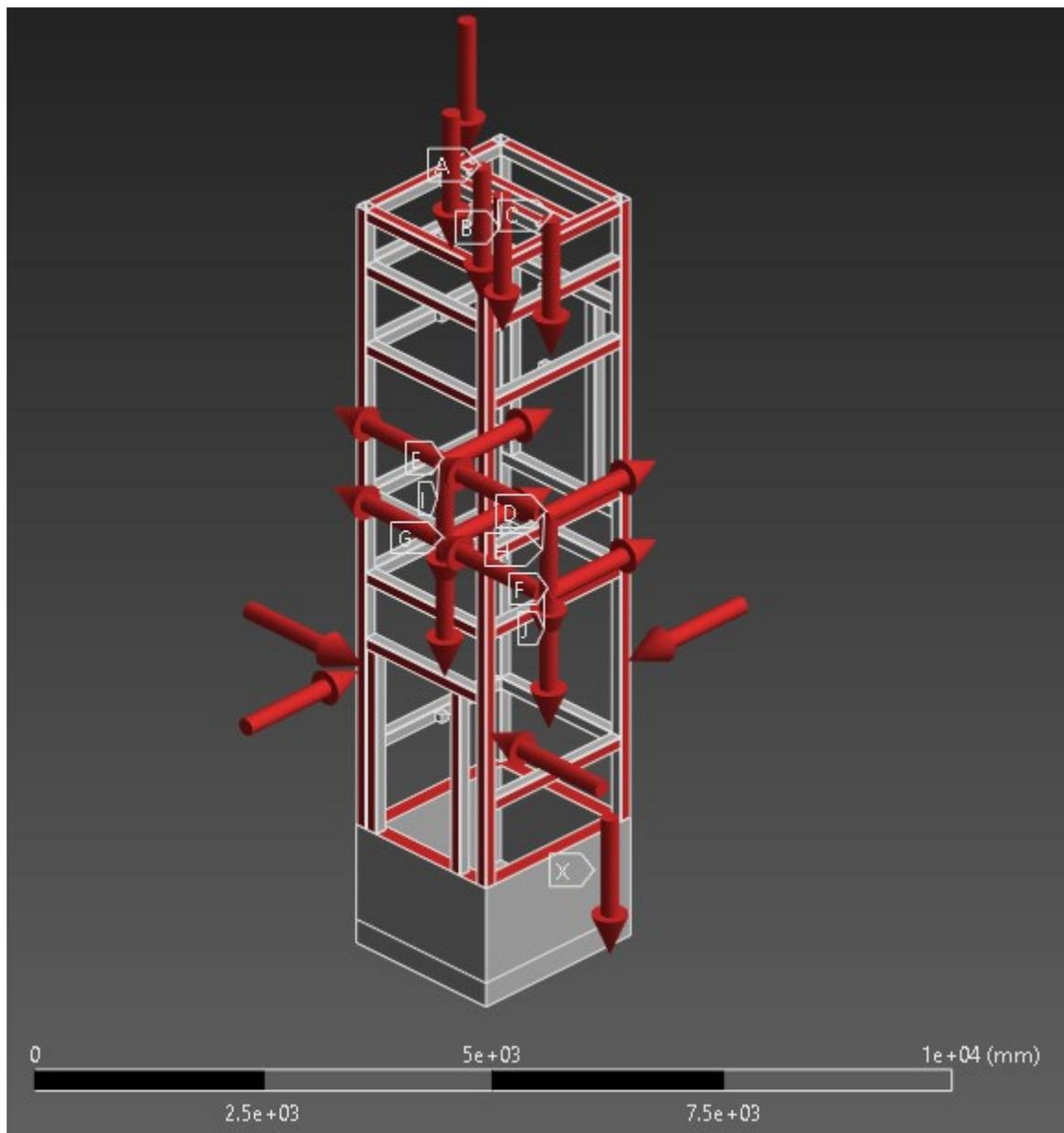
Slika 42. Skica rasporeda opterećenja u slučaju Bočni udari 3
