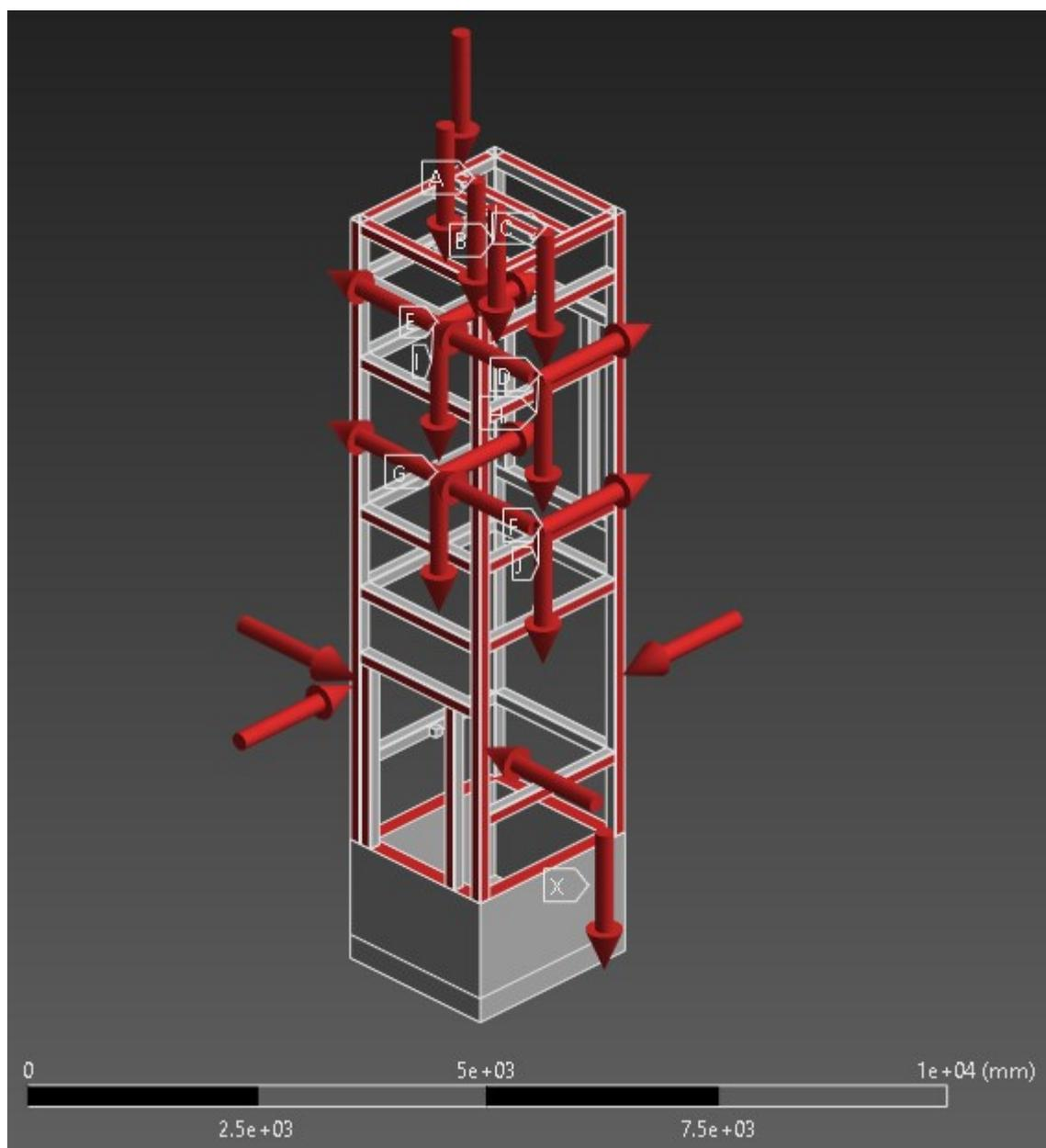
Slika 41. Skica rasporeda opterećenja u slučaju Bočni udari 2
