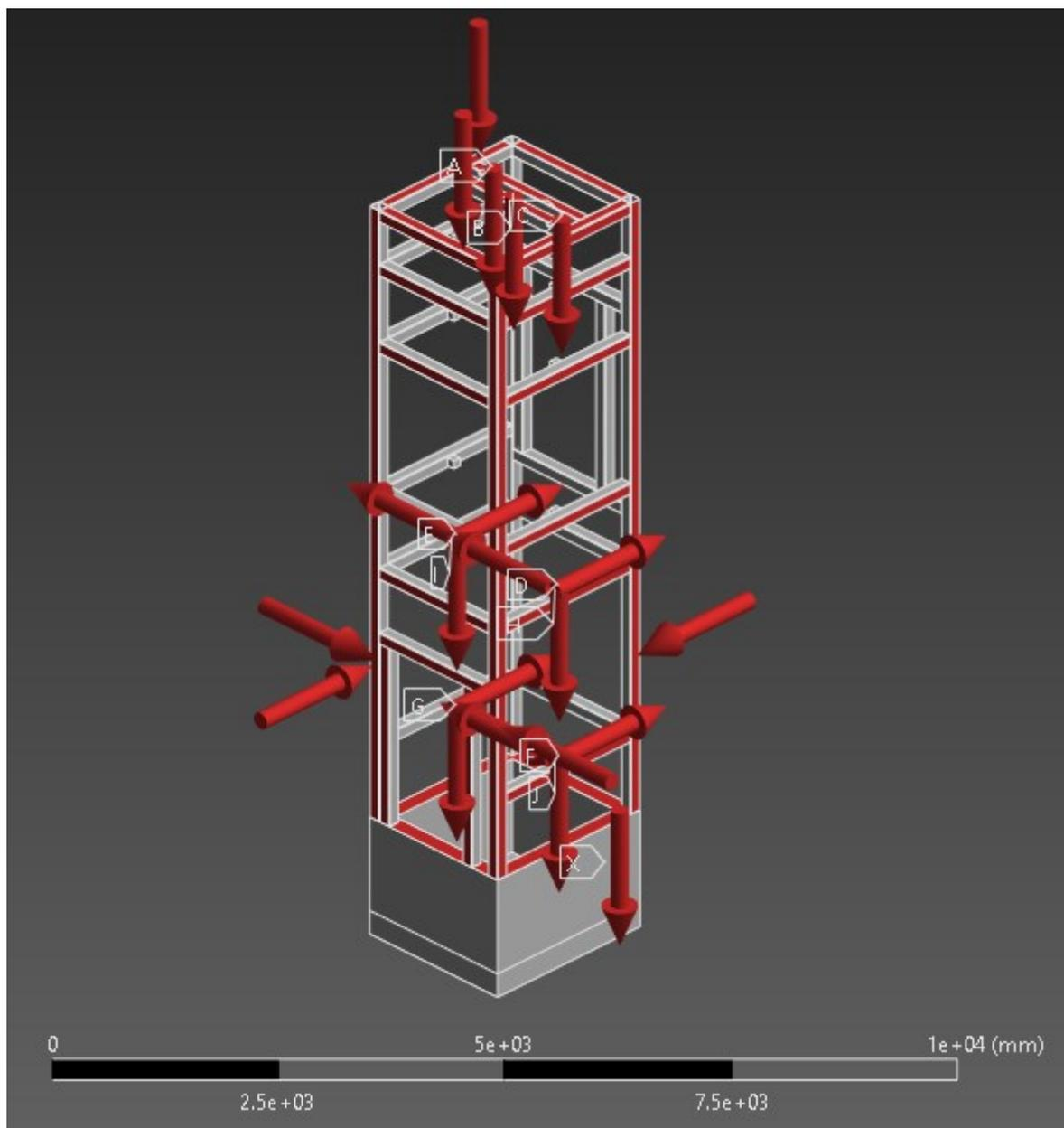
Slika 44. Skica rasporeda opterećenja u slučaju Bočni udari 4
