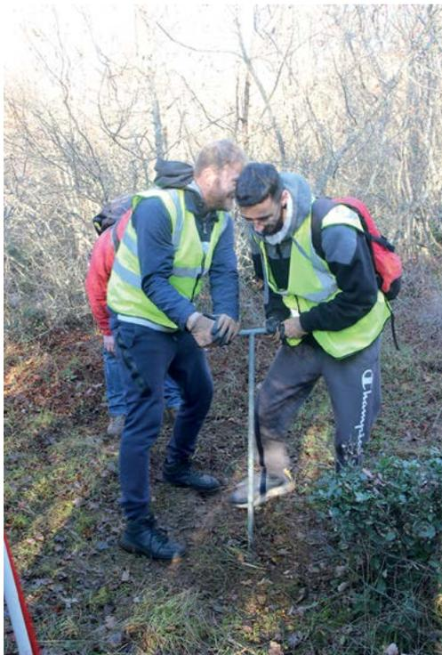
*Slika 136: Sondiranje tla ručnim svrdlom.*
