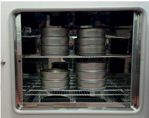
*Slika 96: Sušenje uzoraka u sitima, u sušioniku.*
