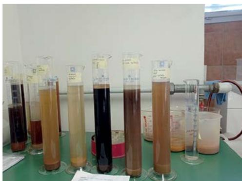
*Slika 98: Sedimentacijska analiza.*
