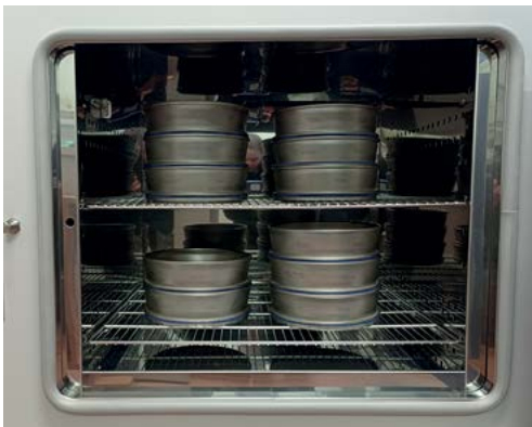
Slika 96: Sušenje uzoraka u sitima, u sušioniku.
