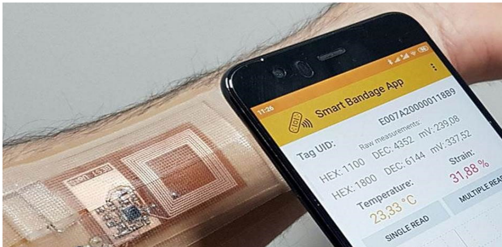
Slika 3. Pametni kompresijski flaster sa integriranim savitljivim senzorom
