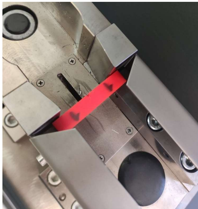
Slika 14: Charpy-jeva epruveta u horizontalnim držačima – ABS
