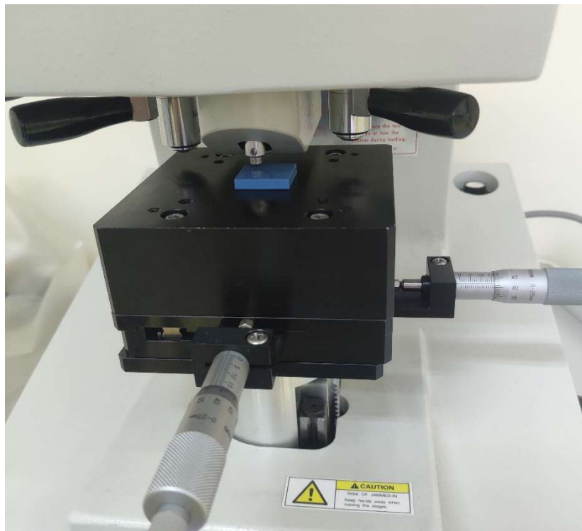
Slika 37: Utiskivanje dijamantne piramide u pločicu materijala
