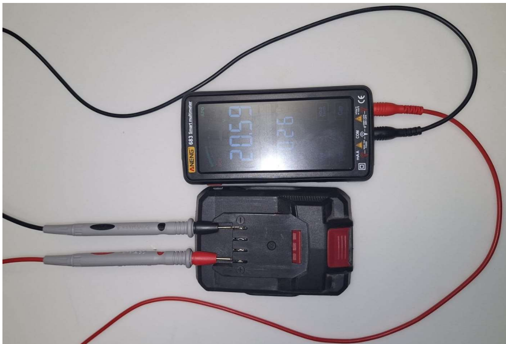
Slika 65: Multimetar u direktnom kontaktu s baterijom
