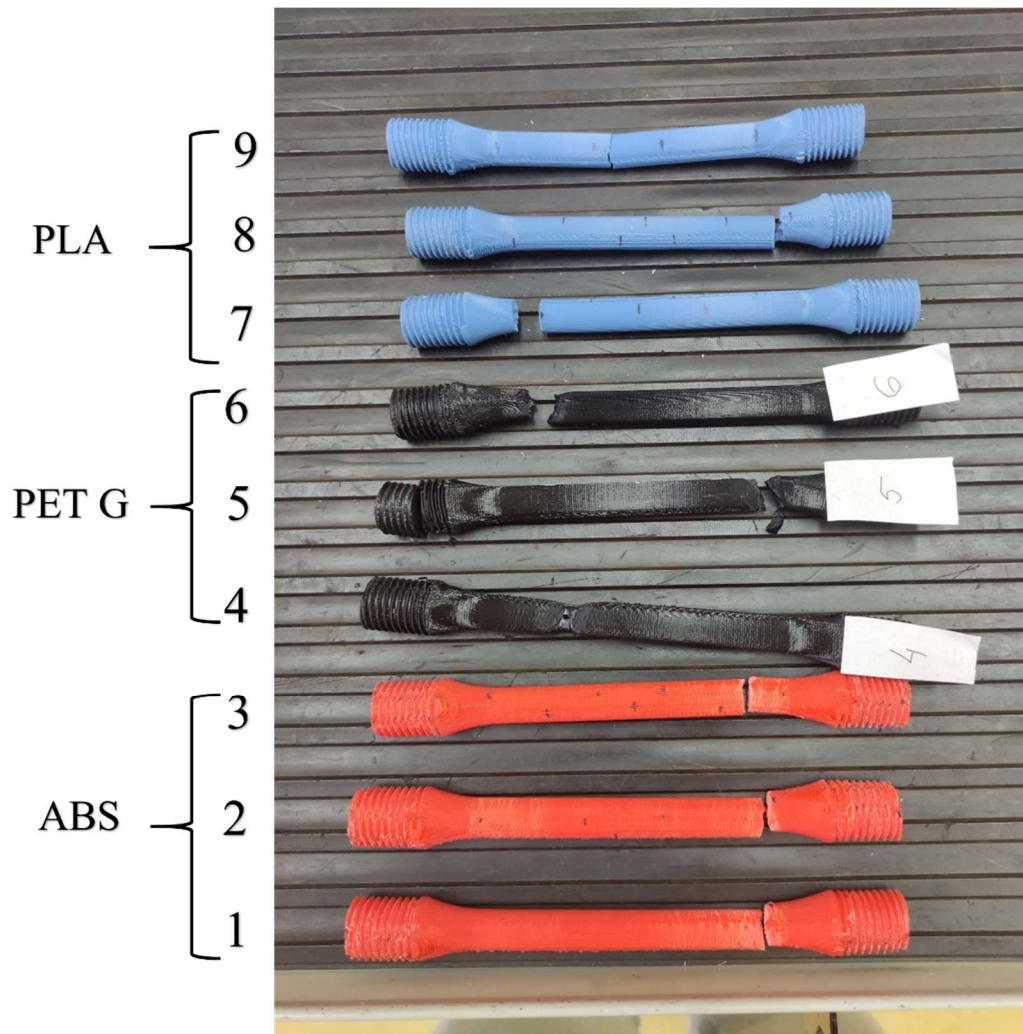
Slika 35: Stanje epruветa nakon vlačnog statičkog ispitivanja
