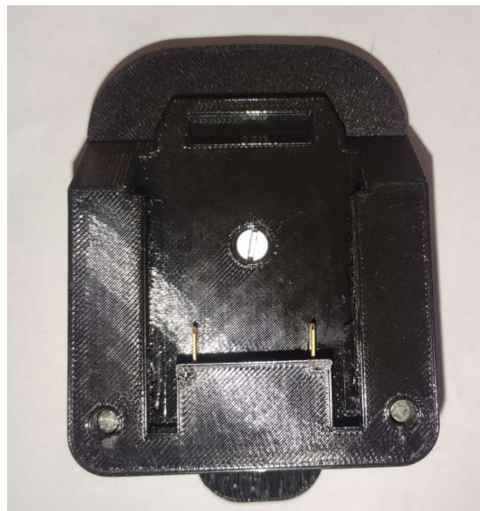
Slika 62: Dijelovi spojnog elementa spojeni šarafima
