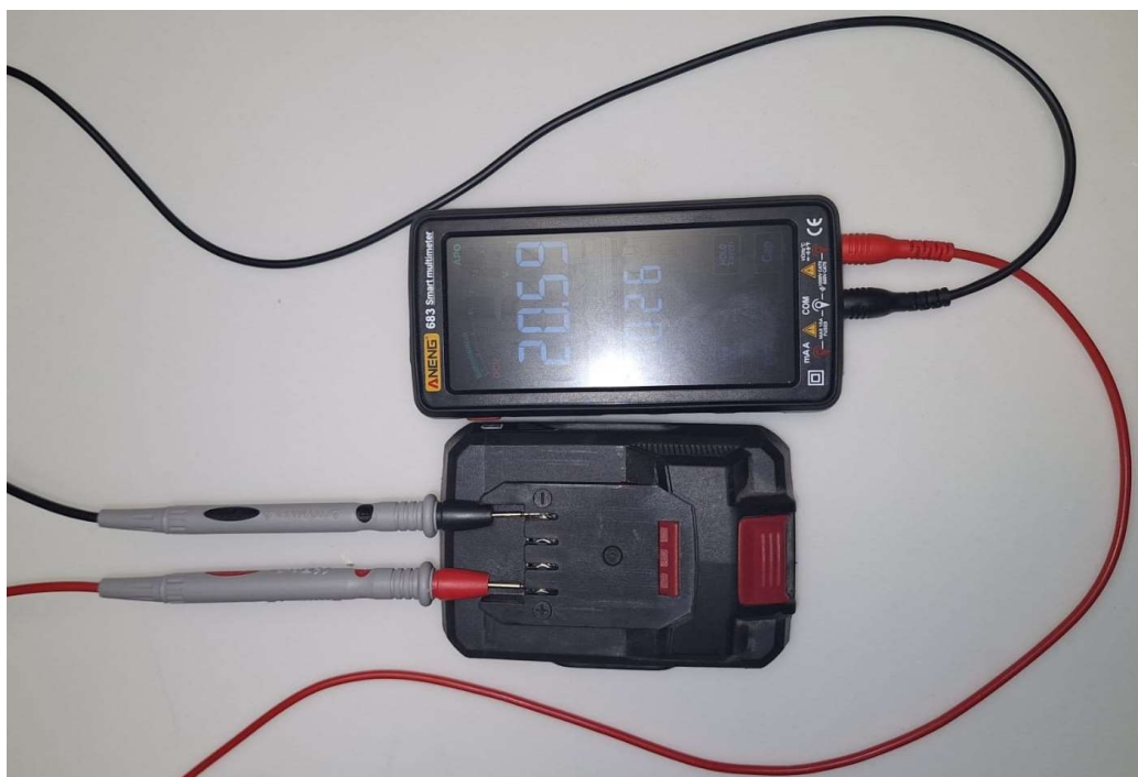
Slika 65: Multimetar u direktnom kontaktu s baterijom
