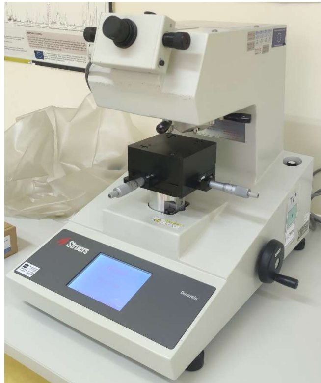
Slika 38: STRUERS DURAMIN 2 mikrotvrdomjer
