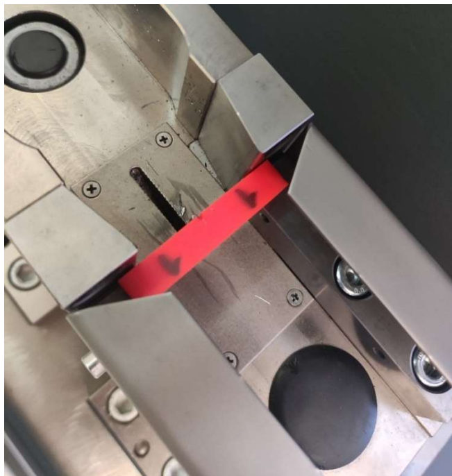
Slika 14: Charpy-jeva epruveta u horizontalnim držačima – ABS
