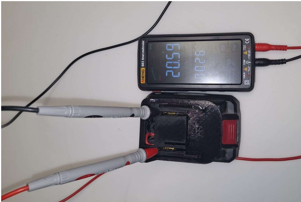
Slika 66: Multimetar u kontaktu sa spojnim elementom spojeimn sa baterijom
