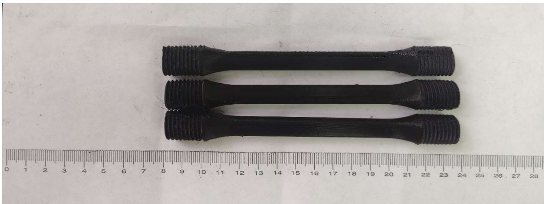
Slika 8: Epruveta - PET G materijal
