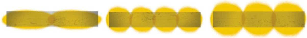
Slika 4.5.4. Primjer dobrog podmazivanja [9]
