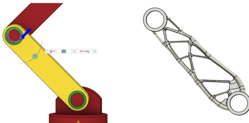
Slika 44 Generativni dizajn robotske ruke 3/4
