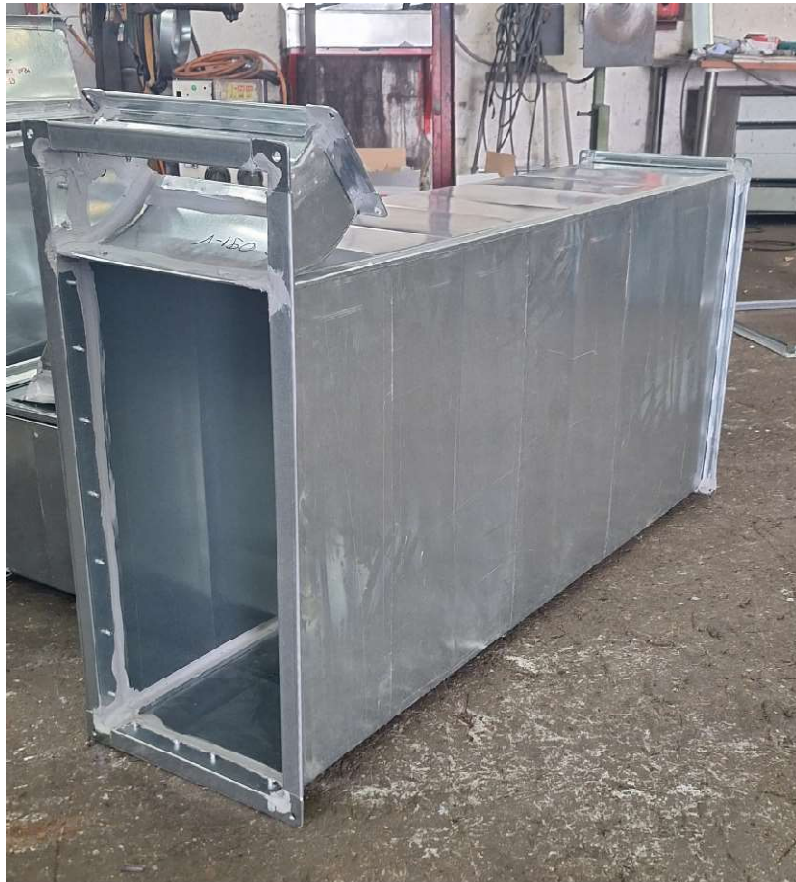
Slika 18 Montirana konstrukcija ventilacijskog odvoda
