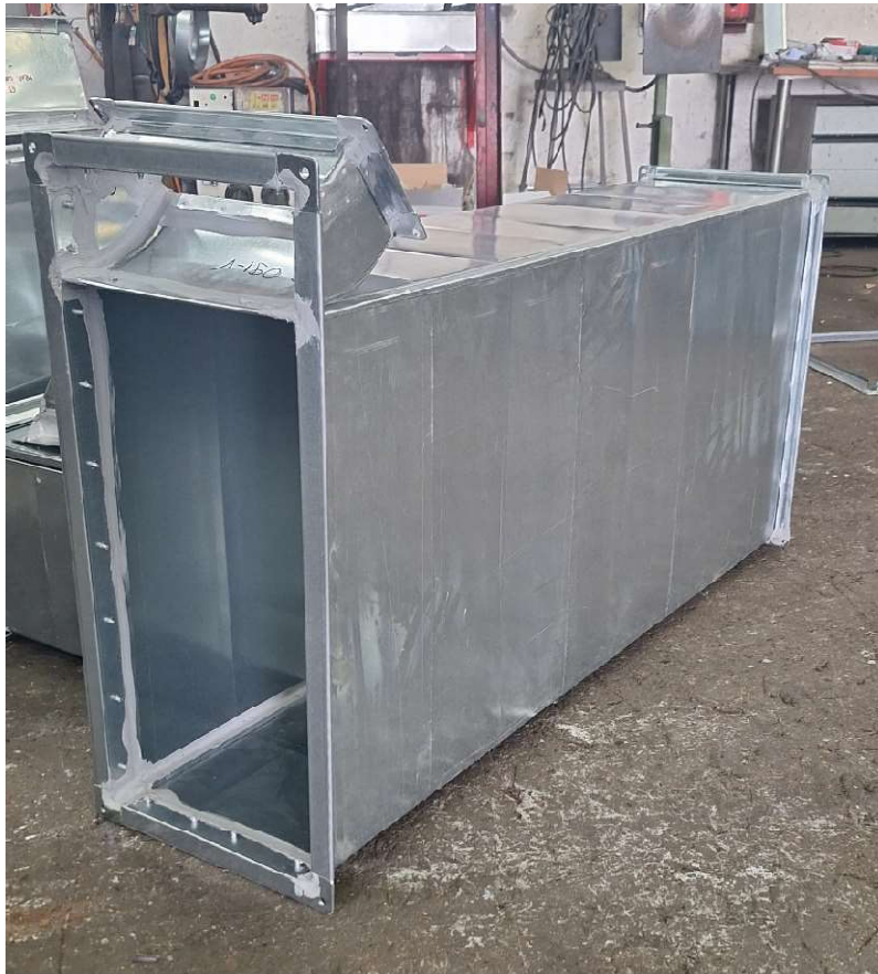
Slika 18 Montirana konstrukcija ventilacijskog odvoda
