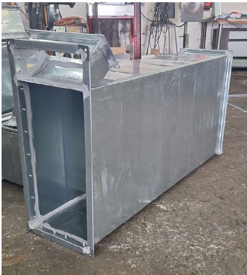
Slika 18 Montirana konstrukcija ventilacijskog odvoda
