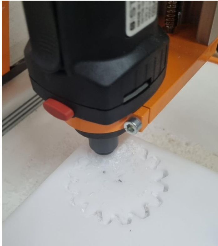
Slika 20 Prikaz izrade zupčanika
