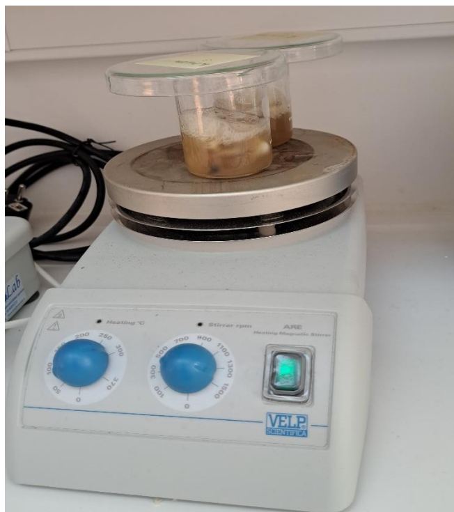
Slika 7. Digestija uzoraka pomoću magnetske mješalice
