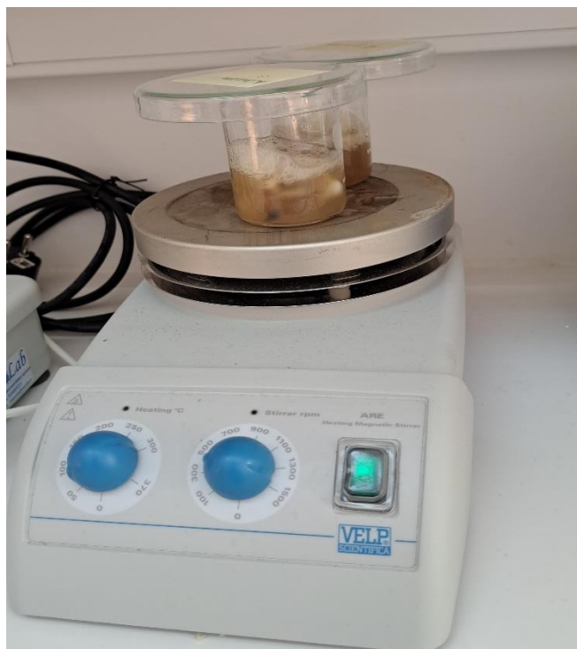
Slika 7. Digestija uzoraka pomoću magnetske mješalice
