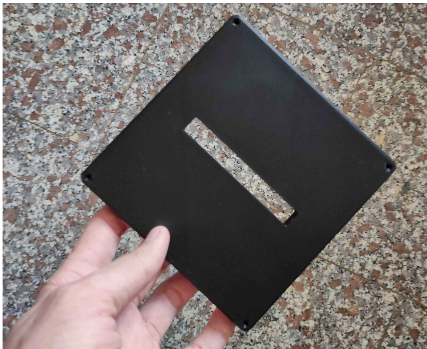
Slika 68: Krivo dimenzioniran poklopac kućišta
