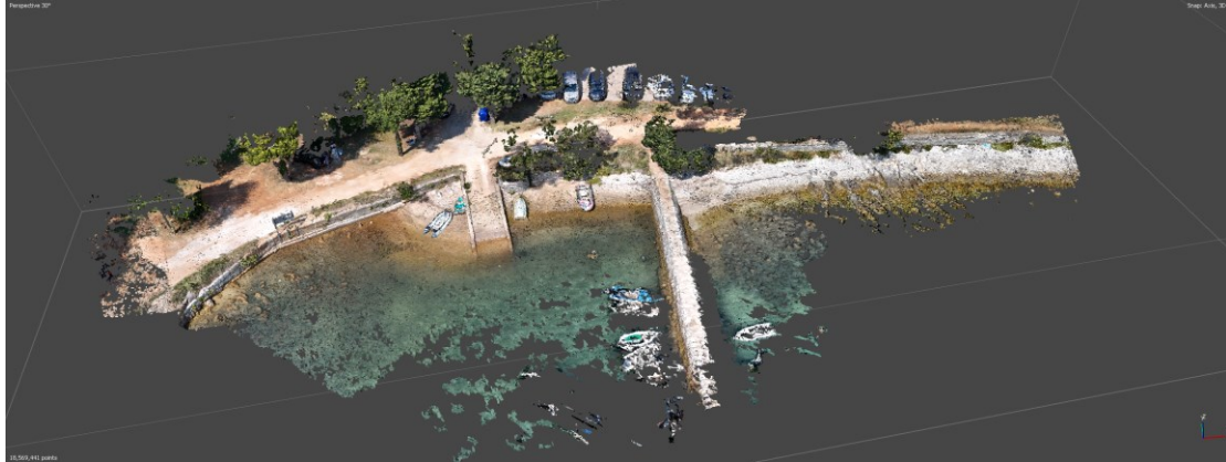
Slika 19. Prikaz generiranog gustog točkastog oblaka male lučice.
