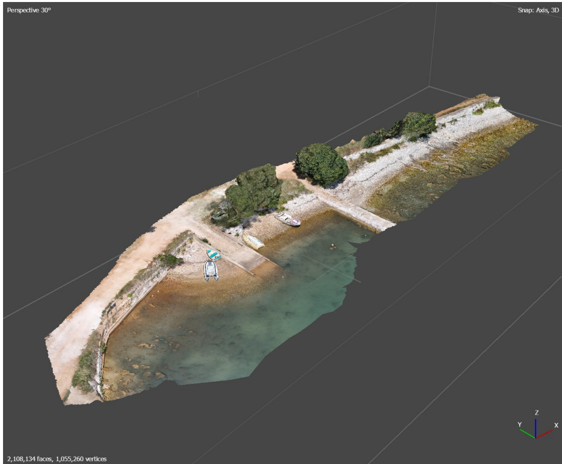
Slika 32. Procesuiran fotogrametrijski 3d model male lučice napravljen pomoću zračne snimke dronom DJI.
