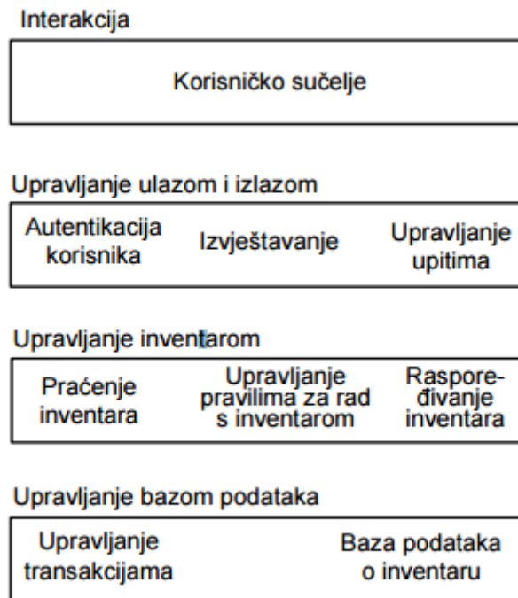
Slika 7.: Referentna arhitektura linije programskih proizvoda za upravljanje inventarom
