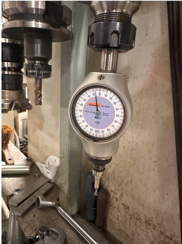
Slika 32. Alat za provjeravanje ravnosti, kružnosti i ostalih tolerancija oblika i položaja
