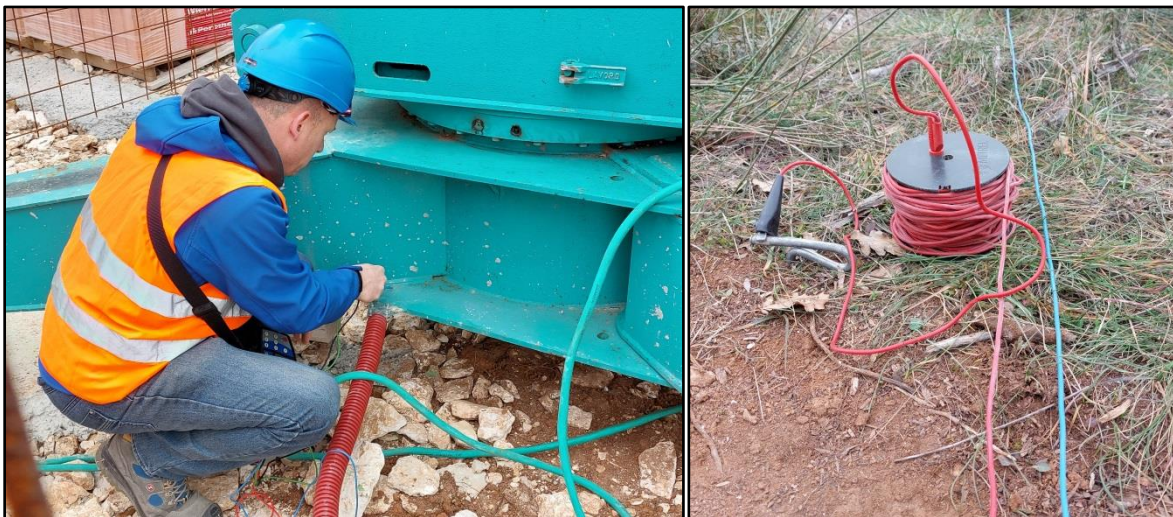
Slika 9: Ispitivanje otpora uzemljenja instrumentom Metrel Eurotest XA
