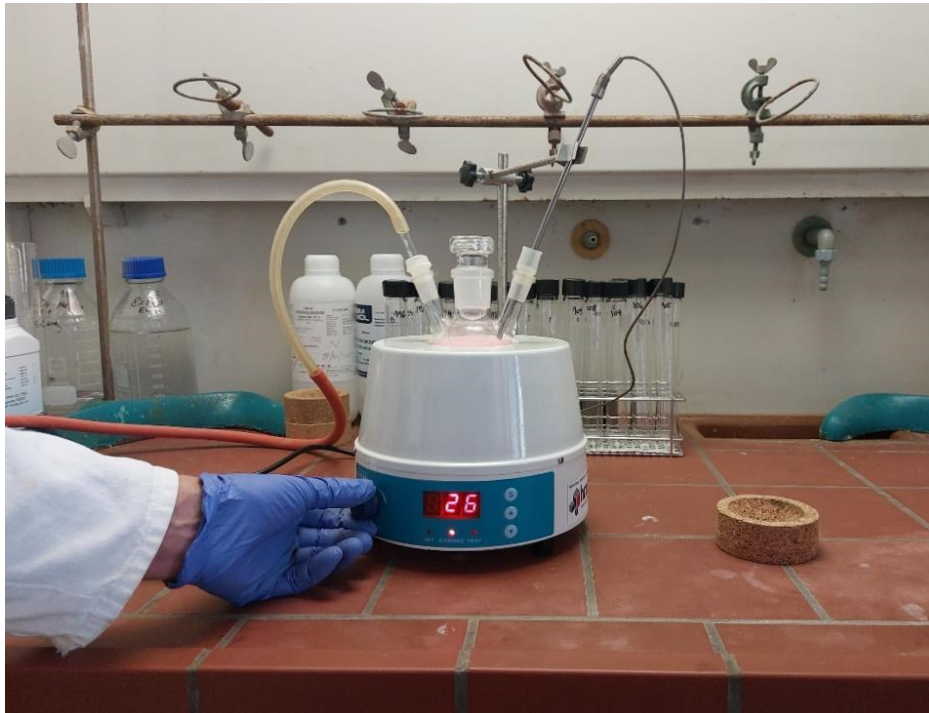
Slika 2.2. Aparatura i reakcijska posuda za sintezu polimernih nanočestica. S lijeve strane nalazi se cjevčica koja dovodi dušik, a s desne strane termometar.
