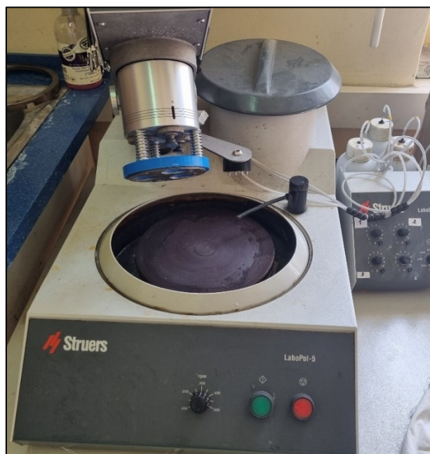
Slika 60. Uređaj za poliranje "STRUERS LaboPol-5"
