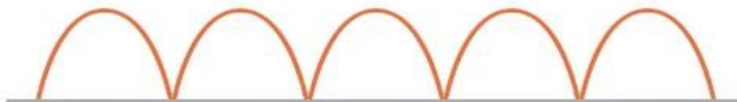
Slika 12 Prikaz napona bez kondenzatora
