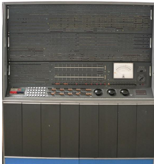
Slika 1.- Stretchova konzola za održavanje
