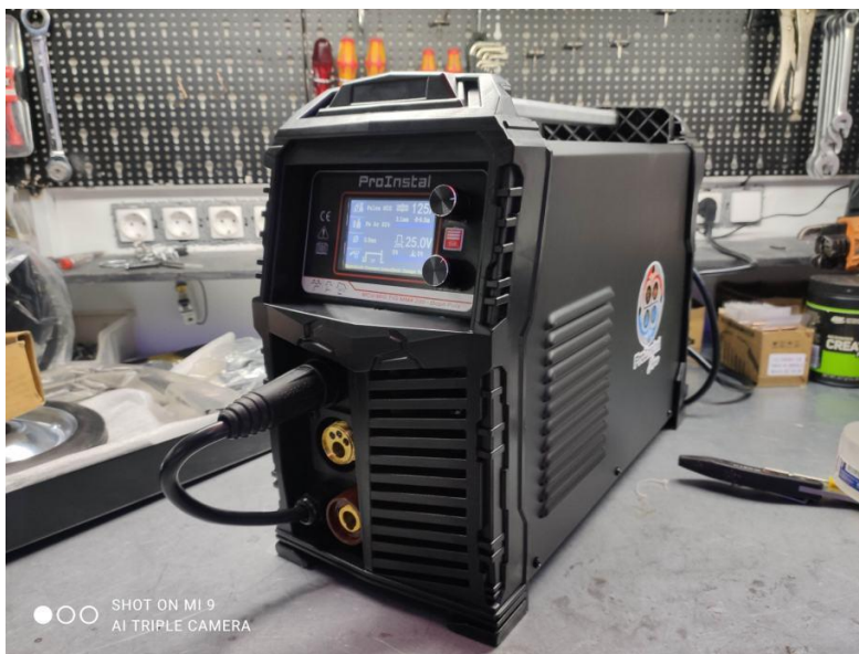
Sl.13 slika pulsnog aparata koji se koristi za prijenos metala pomoću električne struje, izvor: https://proinstal.hr/shop/aparati-zavarivanje-varenje/mig-mag-fcaw-co2/dupli-pulsni-co2-aparat-za-varenje-mig-tig-mma-200a/ (17.9.2024)
