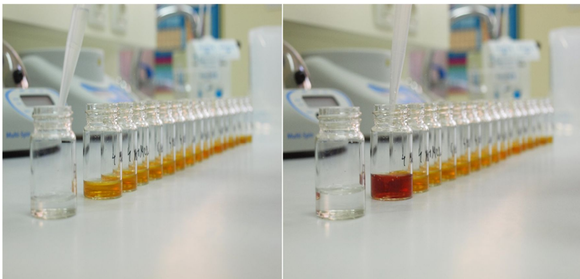
Slika 18. Završna faza pripreme uzoraka za određivanje koncentracije ukupnih flavonoida. Dodatkom aluminij-klorida uzorci mijenjaju boju čiji intenzitet ovisi o koncentraciji ukupnih flavonoida u uzorku.
