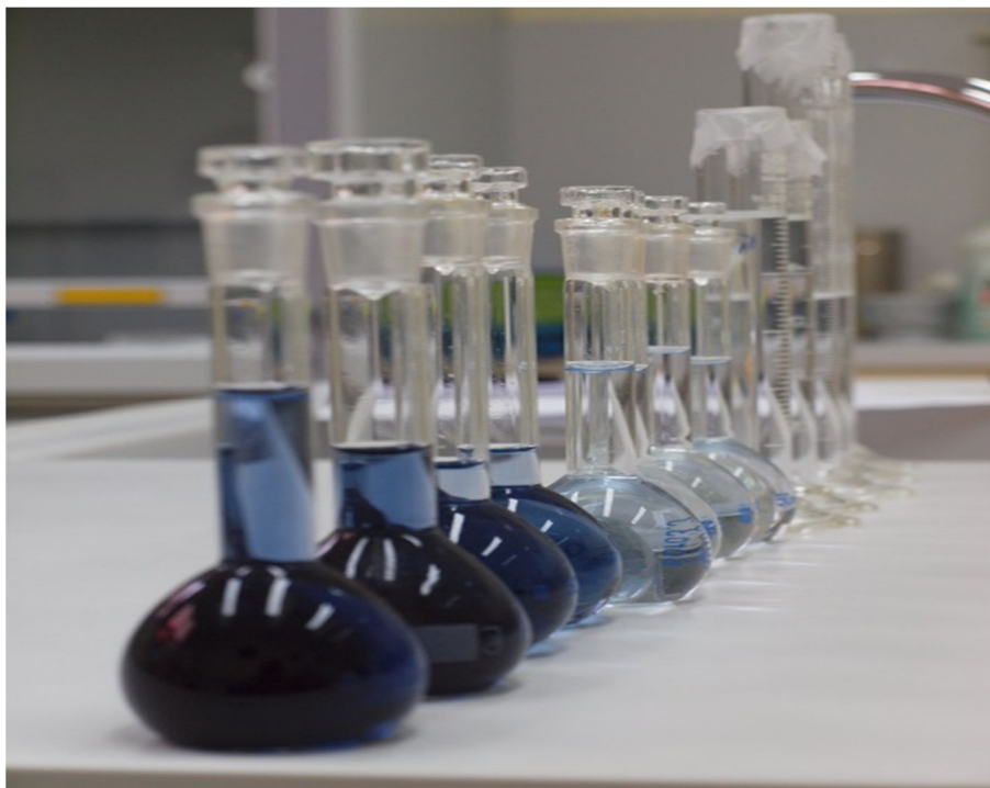
Slika 16. Uzorci pripremljeni za spektrofotometrijsko određivanje koncentracije ukupnih fenola. Veća koncentracija fenola- jače plavo obojenje (vlastiti izvor)
