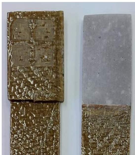
Slika 34. Različite izvedbe jezičaka na epruvetama [Izvor: Autor]
