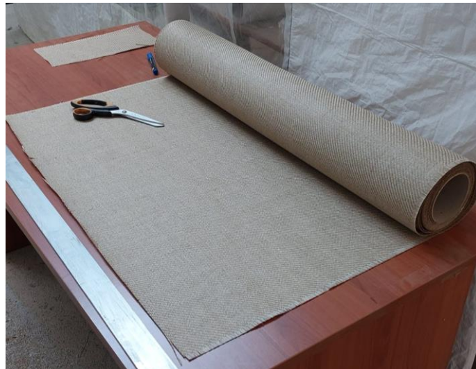
Slika 27. Tkana lanena vlakna u roli [Izvor: Autor]
