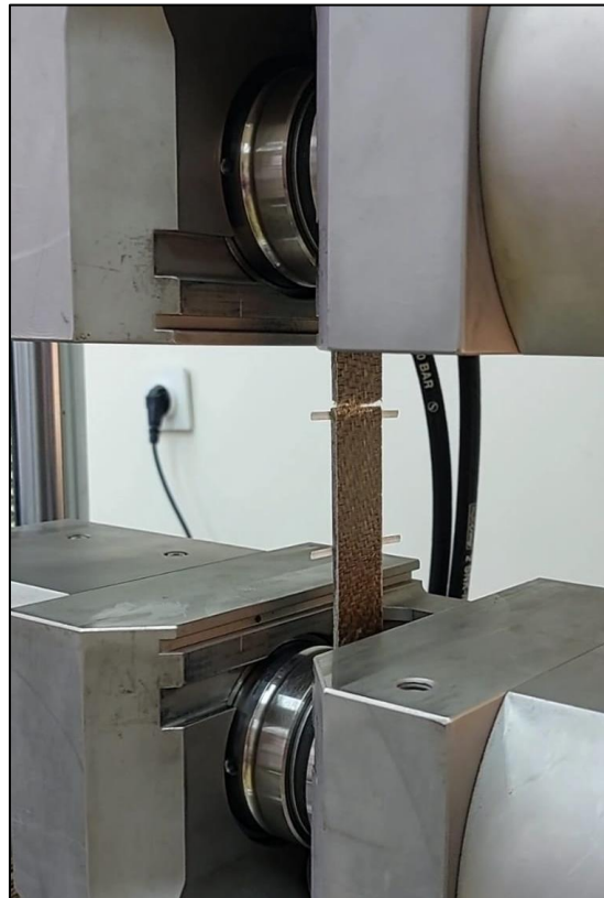
Slika 41. Puknuće epruvete pri ispitivanju [Izvor: Autor]
